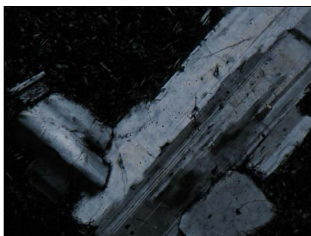
Φωτογραφία 12. Κρύσταλλος πλαγιοκλάστων που ανήκει στο δείγμα V7της Ελατιάς. Αριστερά ο κρύσταλλος φαίνεται με πολωτή και δεξιά με πολωτή και αναλυτή. Χαρακτηριστικές είναι οι διδυμίες που φαίνονται. Η κατακόρυφη διάσταση είναι 1,2mm.
