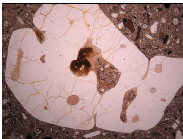
Φωτογραφία 9. Κρύσταλλος χαλαζία που ανήκει στο δείγμα N12 της Ελατιάς. Αριστερά ο κρύσταλλος φαίνεται με πολωτή ενώ δεξιά με πολωτή και αναλυτή. Παρατηρούμε ότι ο κρύσταλλος έχει υπόστει μαγματική διάβρωση. Η κατακόρυφη διάσταση είναι 5mm.
