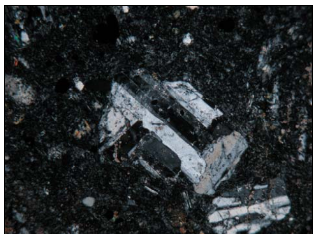
Φωτογραφία 3. Κρύσταλλος πλαγιокλάστων που ανήκει στο δείγμα A12-a της Ελατιάς. Αριστερά ο κρύσταλλος φαίνεται με πολωτή ενώ δεξιά με πολωτή και αναλυτή. Η κατακόρυφη διάσταση είναι 5mm.
