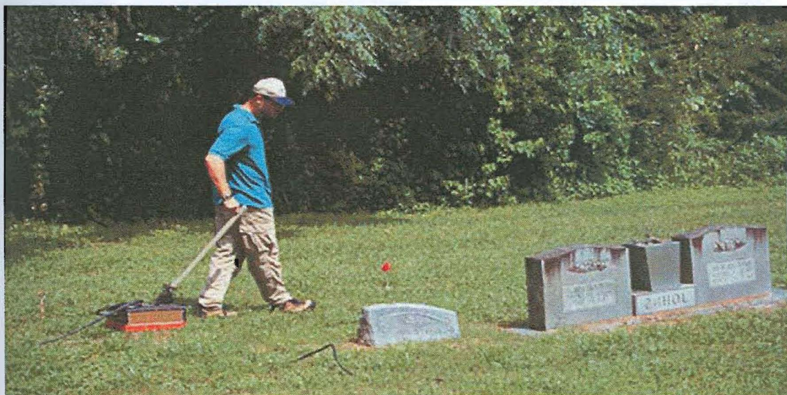
Εικ.9 Ανίχνευση θαμμένων αντικειμένων με την χρήση του υπεδαφίου ραντάρ (GPR). (URL 14)
