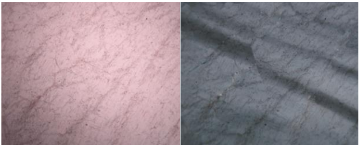
KE4562: Χαλαζίας (Qz). Η αριστερή φωτογραφία αντιστοιχεί σε N// και η δεξιά σε N+. Η μεγάλη πλευρά των φωτογραφιών αντιστοιχεί σε 2.8 mm. Η μεγέθυνση είναι x5.
