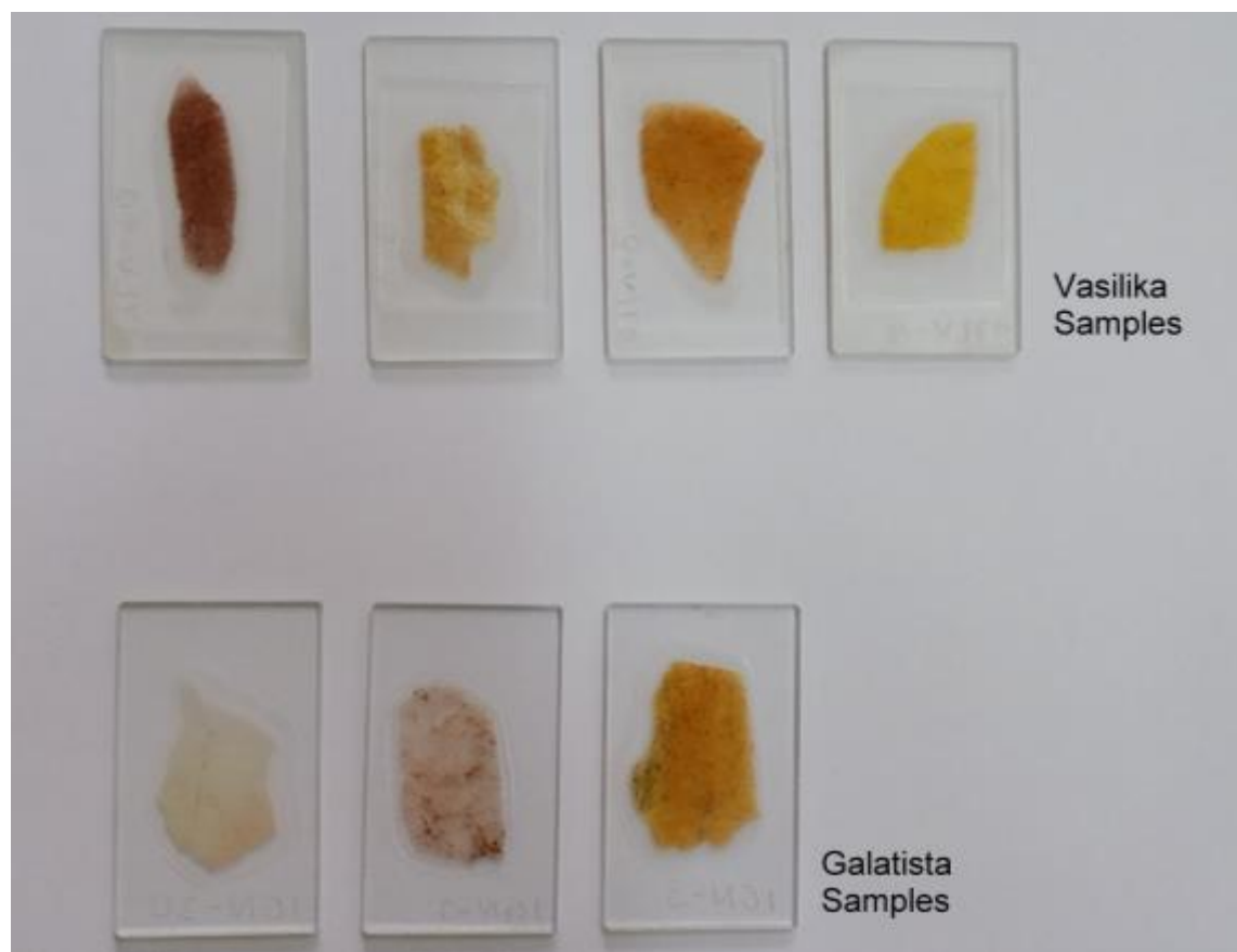
Σχήμα 3.2.2. Οι λεπτές τομές των δειγμάτων από τα Βασιλικά και την Γαλάτιστα.
