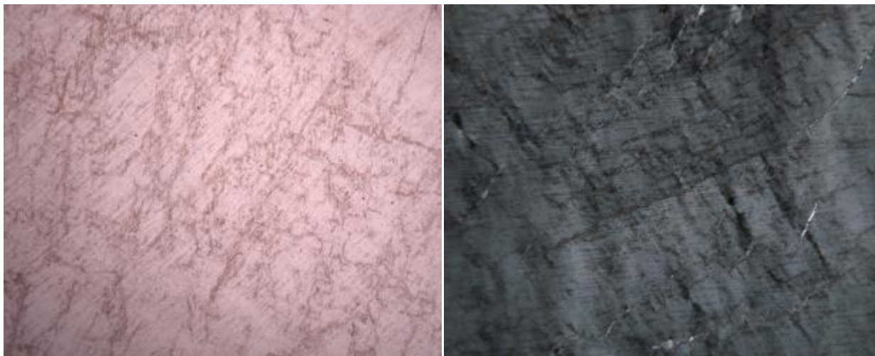
ΚΕ4692: Χαλαζίας (Qz). Η αριστερή φωτογραφία αντιστοιχεί σε N// και η δεξιά σε N+. Η μεγάλη πλευρά των φωτογραφιών αντιστοιχεί σε 2.8 mm. Η μεγέθυνση είναι x5.
