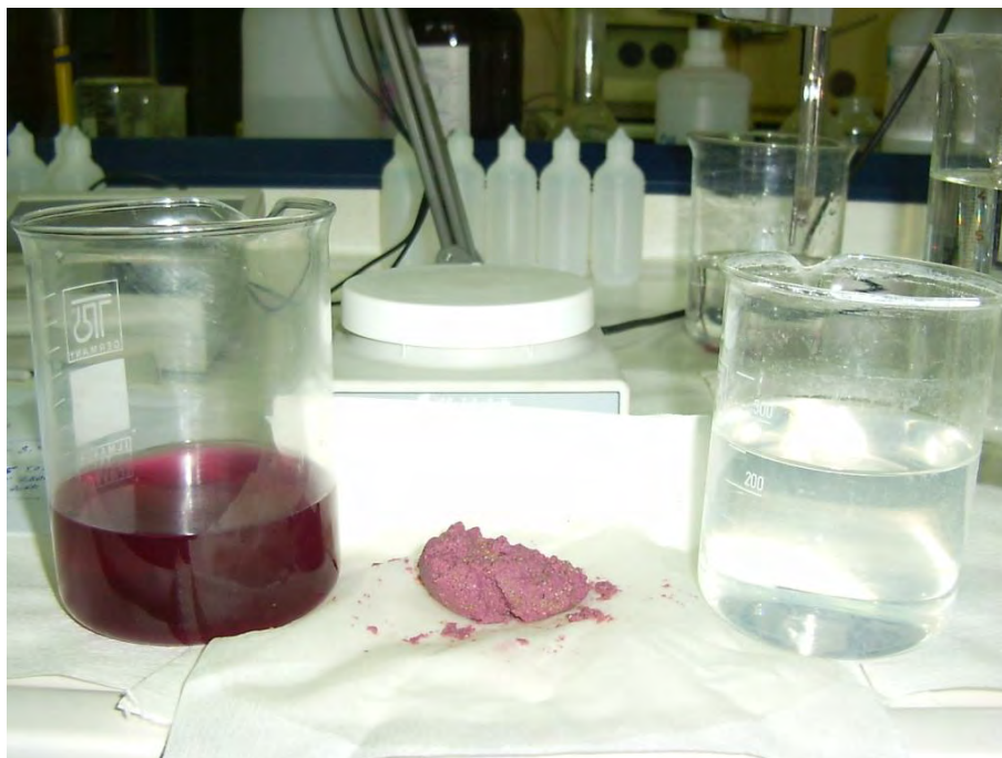
Σχήμα 5.1. (Αριστερά) Αρχικά βιομηχανικά υγρά απόβλητα βαφείου, (Κέντρο) Άοσμη-συνεκτική ζεο-λάσπη, (Δεξιά) Διαυγές νερό μετά την κατεργασία με πολύ υψηλής ποιότητας ζεολιθικό τόφο (Φιλιππίδης κ.α. 2007α).
