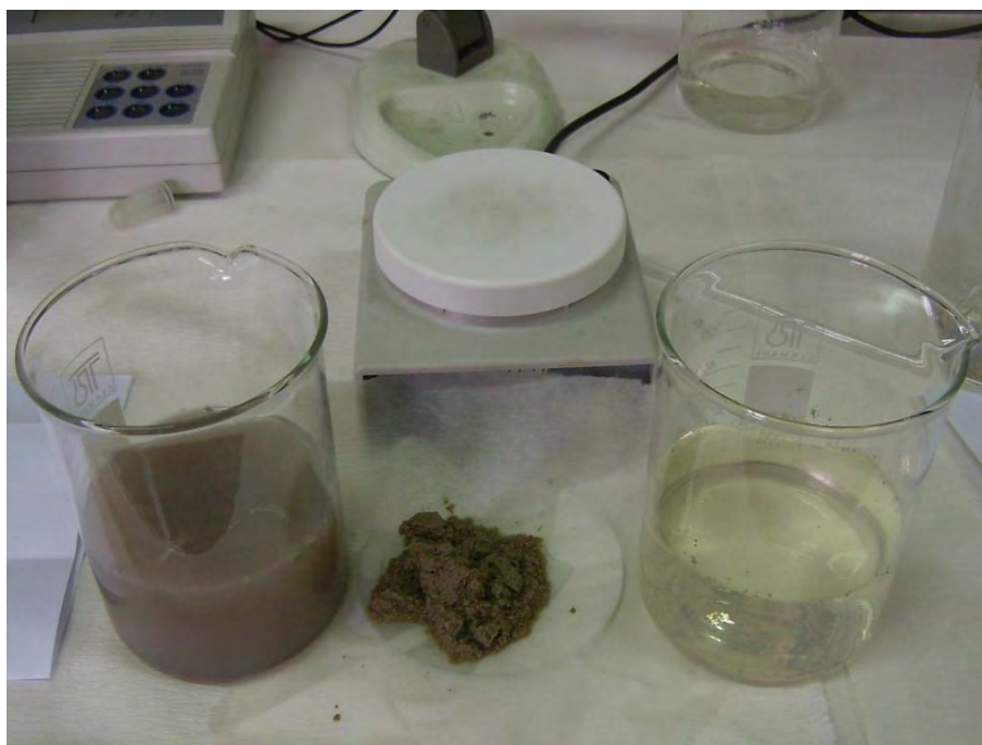
Σχήμα 5.2. (Αριστερά) Αρχικά βιομηχανικά υγρά απόβλητα βυρσοδεψείου, (Κέντρο) Άοσμη-συνεκτική ζεο-λάσπη, (Δεξιά) Διαυγές νερό μετά την κατεργασία με πολύ υψηλής ποιότητας ζεολιθικό τόφο (Φιλιππίδης κ.α. 2007α).
