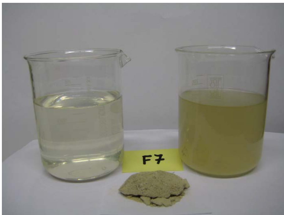
Σχήμα 4.1. (Δεξιά) Αρχικά αστικά λύματα, (Κέντρο) Άοσμη-συνεκτική ζεολυματολάσπη, (Αριστερά) Διαυγές νερό μετά την κατεργασία με πολύ υψηλής ποιότητας ζεολιθικό τόφφο (Φιλιππίδης κ.α. 2007α).
