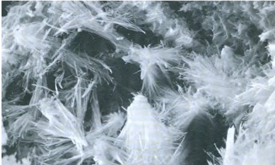
Σχήμα 2.2. Ινώδης Μορντενίτης. Μικροφωτογραφία σαρωτικού ηλεκτρονικού μικροσκοπίου (SEM), Οριζόντια διάσταση 1 cm (Gottardi & Galli 1985).
