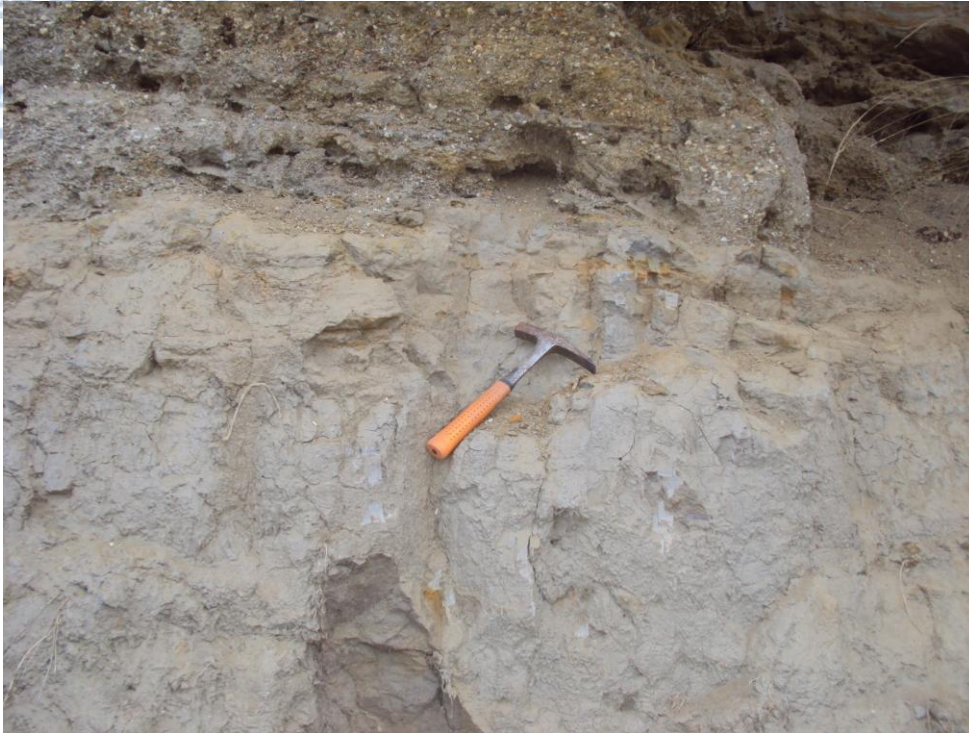
Εικόνα 8. Παχύ στρώμα ιλύος με πολλαπλούς οξειδωμένους ορίζοντες που μεταβαίνει σε κροκαλοπαγές.
