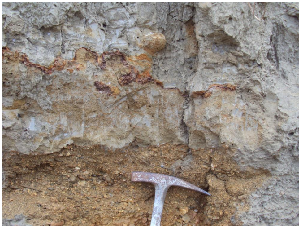
Εικόνα 7. Το ημικροκαλοπηλοαμμώδες στρώμα και ο οξειδωμένος ορίζοντας με την πτυχοειδή μορφή στην οροφή του στρώματος.
