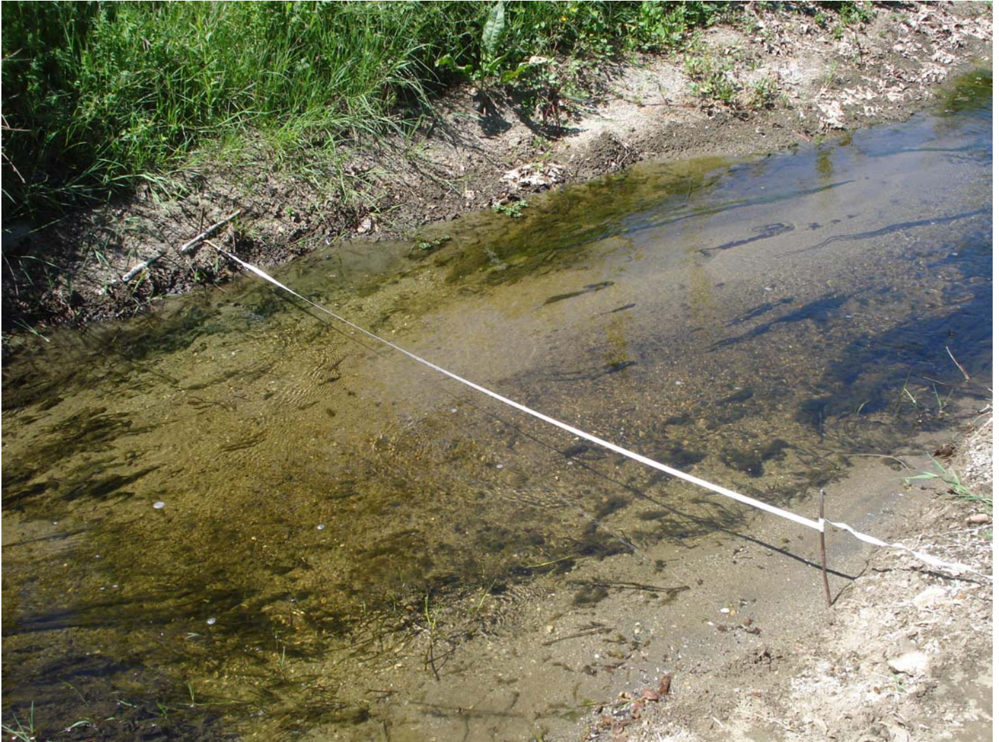
Σχήμα 3.2.1: Βήμα 1: Καθαρίζεται η περιοχή του ρέματος που θα μελετήσουμε και τοποθετείται η μετροταινία πάντα κάθετα στην ροή
