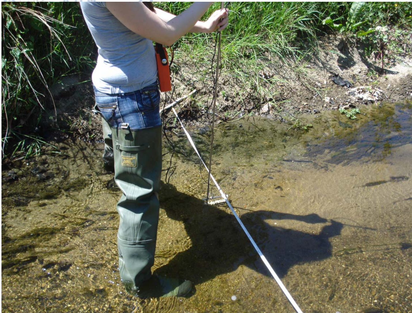
Σχήμα 3.2.5: Βήμα 5: Μηδενίζουμε το στροφόμετρο και επαναλαμβάνουμε την ίδια διαδικασία για κάθε 30 ή 40 εκατοστά μέχρι να φτάσουμε στην άλλη όχθη του ρέματος
