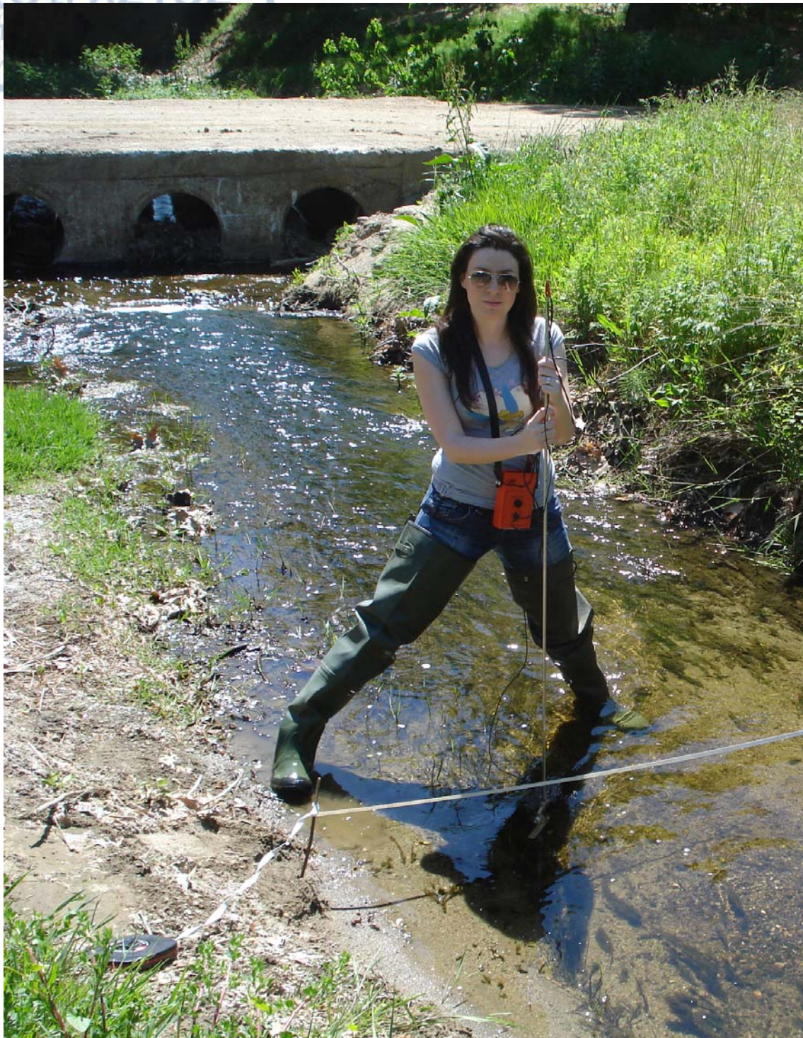
Σχήμα 3.2.4: Βήμα 4: Βυθίζουμε την βάση του οργάνου στον πυθμένα και με την προπέλα προσανατολισμένη κάθετα στην διεύθυνση ροής, κρατώντας πάντα σταθερό το όργανο, μετράμε με το στροφόμετρο τις περιστροφές που θα κάνει η προπέλα γύρω από τον άξονα της κατά την διάρκεια ενός λεπτού
