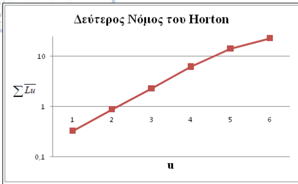
Σχήμα 8.3: Γραφική απεικόνιση του 2ου νόμου Horton, για τη λεκάνη 6ης τάξης.
