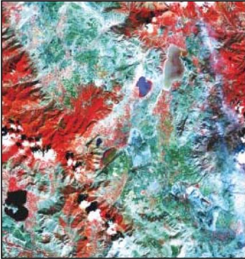
Σχήμα 3: Ενδεικτική κάλυψη (60x60 km) μιας δορυφορικής εικόνας του ASTER δορυφορικού συστήματος με ημερομηνία λήψης τον Οκτώβριο του 2001. Η εικόνα καλύπτει την ευρύτερη περιοχή της λίμνης Βεγορίτιδας. Με το κόκκινο χρώμα απεικονίζονται περιοχές με βλάστηση. Αναγνωρίζονται όλες οι λίμνες της περιοχής με κύρια τη Βεγορίτιδα. (Σύλλογος Προστασίας της λίμνης Βεγορίτιδας).
