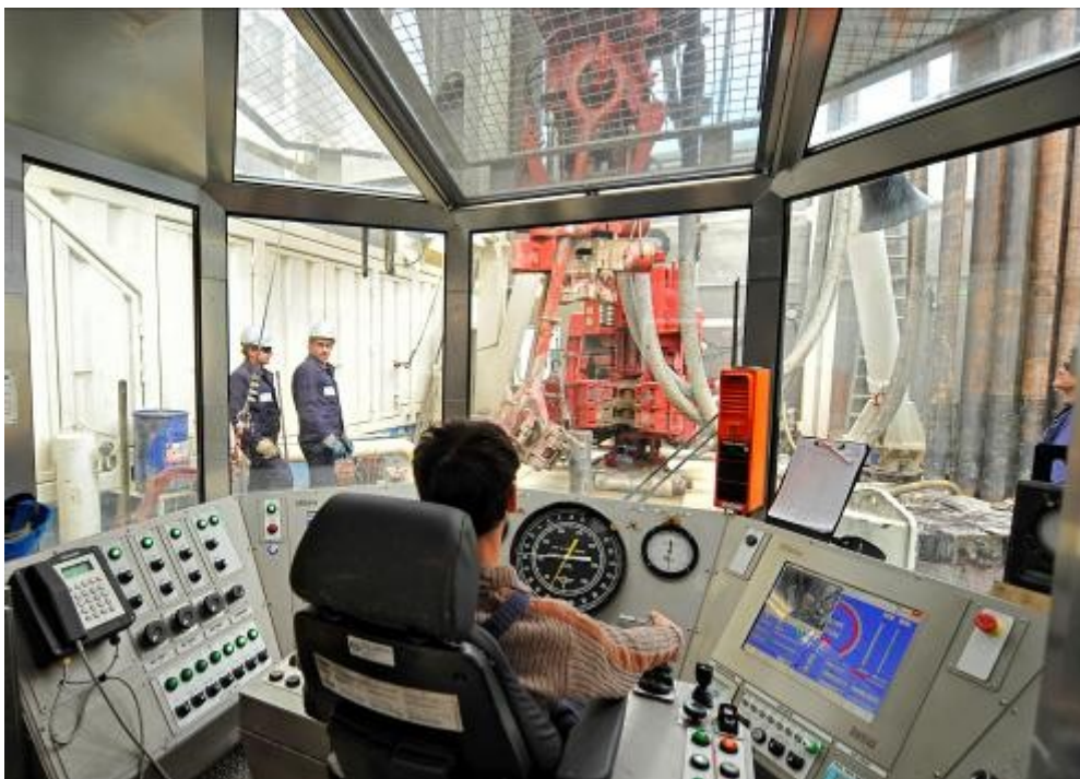
Καμπίνα ελέγχου γεωτρύπανου.
