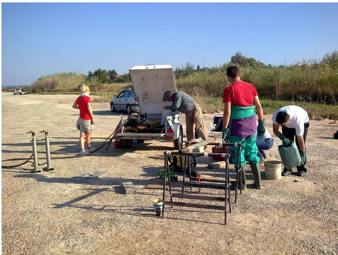
Εικόνα 3.2.1 : Ο εξοπλισμός της γεώτρησης, διακρίνεται ο υδραυλικός εξολκέας στα αριστερά και ο μεταλλικός δειγματολήπτης πάνω στα στηρίγματα
