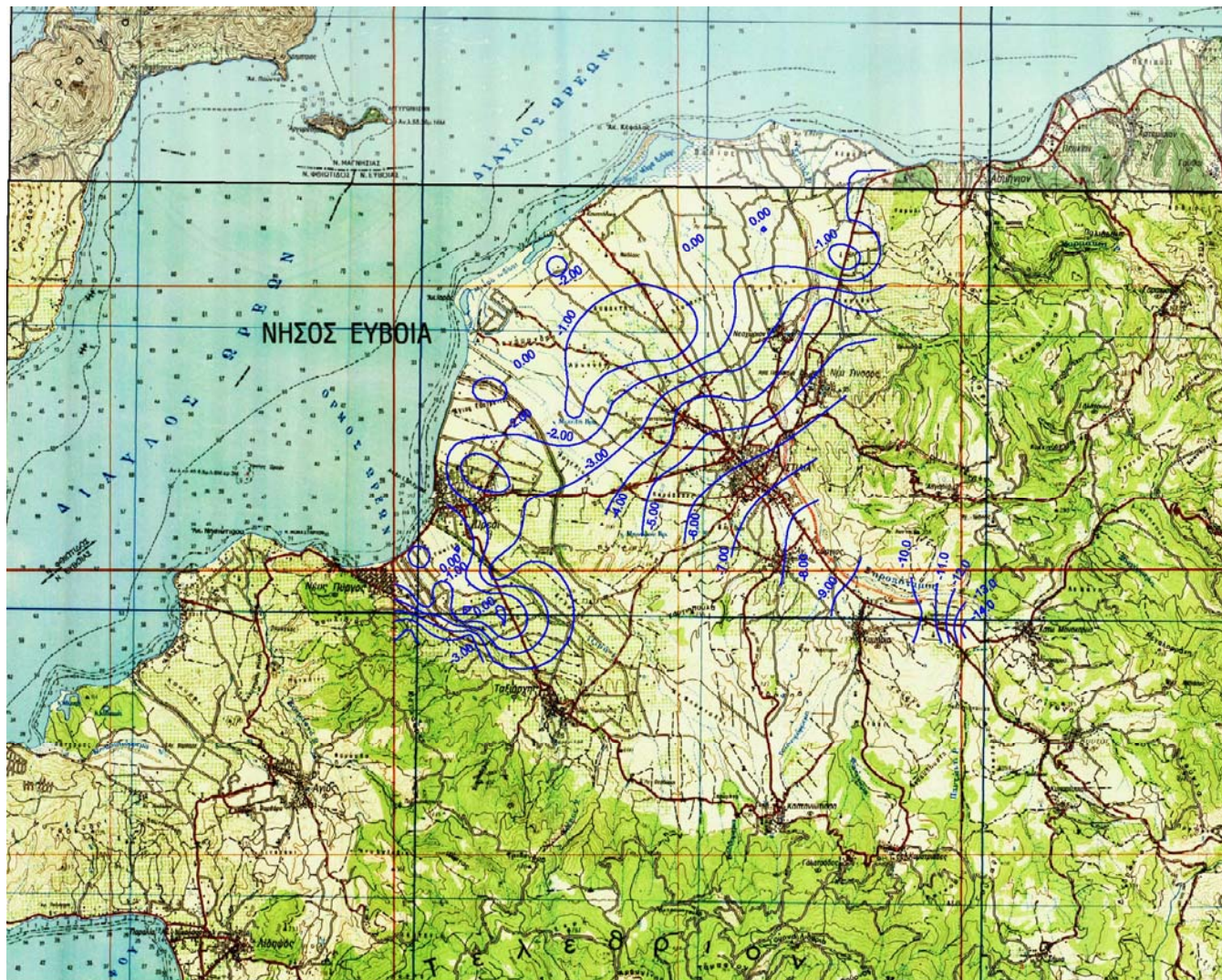
Εικόνα 13. Χάρτης περιοχής Ισθμιαίας με τις καμπύλες ισοβαθών υδροφόρου (Πηγή Γ.Υ.Σ.).
