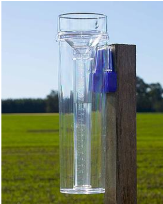
Εικ. 1.4 Βροχόμετρο (δεκαπλασιαστικό). (Πηγή: http://www.stormdebris.net/raingauge.jpg )
