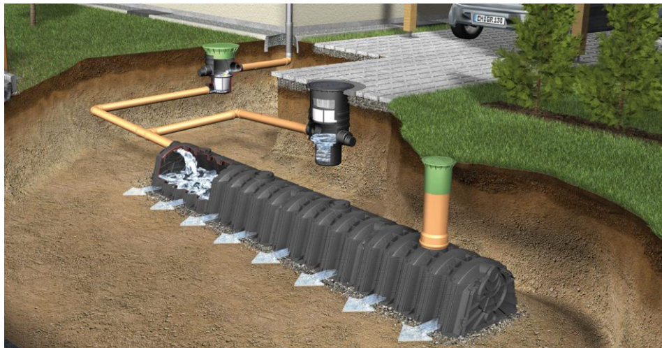
Εικόνα 9 Σύγχρονη σήραγγα συλλογής διηθούμενου νερού ( https://www.graf-water.com/stormwater-management/stormwater-management/infiltration-tunnel/infiltration-tunnel.html ).
