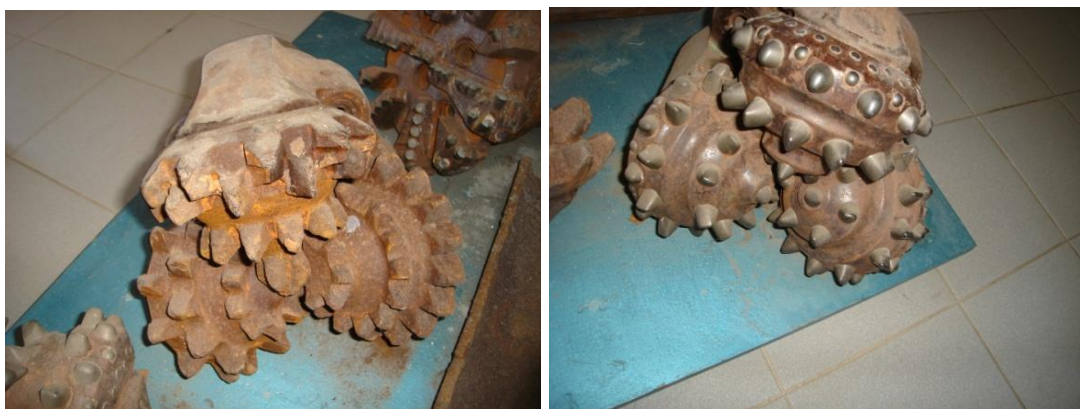
Εικόνα 21 Τρίκωνο κοπτικό άκρο με καρβίδιο βολφραμίου (αριστερά) και με χαλύβδινα δόντια (δεξιά) (Κανέλλος 2014).
