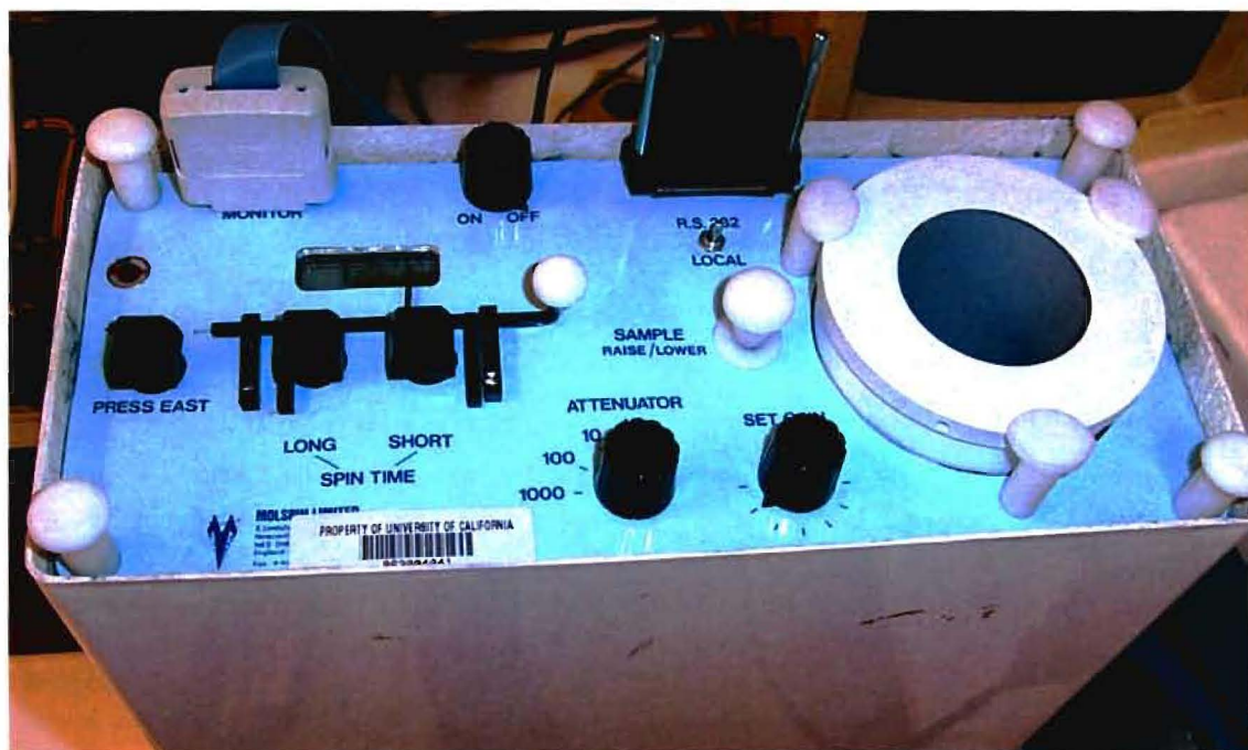
Σχήμα ( 10) Μαγνητόμετρο MINISPIN
