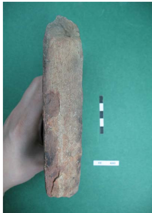
Φωτ. 3.2.2.4. ΚΕ4243, μεταμορφωμένο σχιστολιθικό πέτρωμα. Εμφανής η τάση στρώσεων (Τσιολάκη, 2009).
