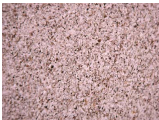
Φωτ. 3.3.3. Τομή Α3. Μετα- ψαμμίτης. Εξαιρετικά λεπτόκοκκο, χαλαζίας και λευκή μαρμαρυγία (ανοιχτόχρωμα ορυκτά), βιοτίτης και κλωρίτης (σκοιρόχρωμα ορυκτά), (α) με N//, (β) με N+.
