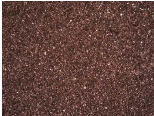
Φωτ. 3.3.14. Τομή B1. Δολερίτης. Εξαιρετικά λεπτόκοκκο με μεγάλο ποσοστό βιοτίτη, επιδότου, κλωρίτη (σκουρόχρωμα- καστανόχρωμα ορυκτά), (α) με N//, (β) με N+.
