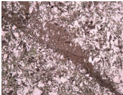
Φωτ. 3.3.6. Τομή Α6. Πρασινοςχιστόλιθος με επικρατέστερα ορυκτά, πλαγιόκλαστο και επίδοτο, (α) με N//, (β) με N+. Εμφάνιση πιο λεπτόκοκκης φλέβας.
