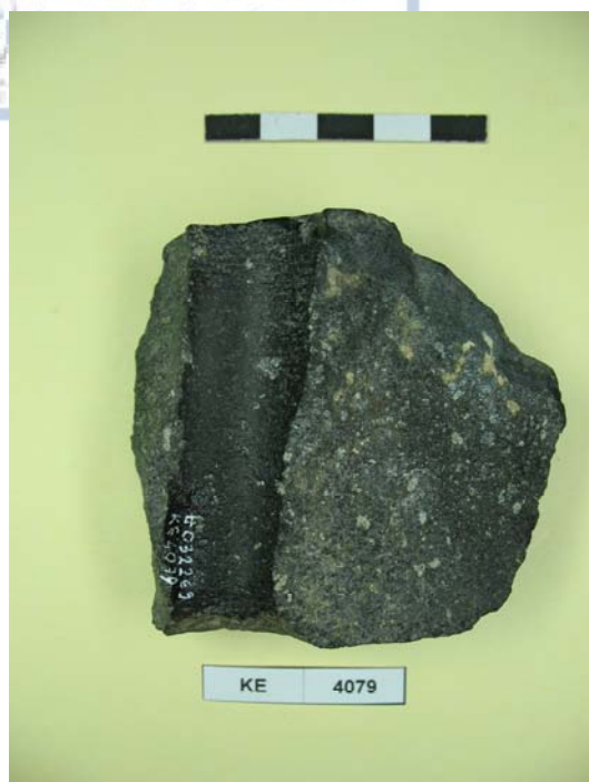
Φωτ. 3.2.2.1. KE4079, πυροξενικός γάββρος. Πυριγενές πέτρωμα με σκούρο τεφρό χρώμα και με χαρακτηριστικούς ανοιχτόχρωμους φαινοκρύσταλλους (Τσιολάκη, 2009).
