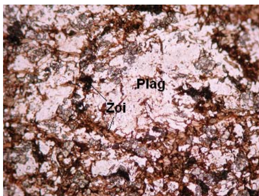
Φωτ. 3.3.9. Τομή Α9. Σχιστόλιθος. Πλαγιόκλαστα και Ζοϊσίτης, (α) με N//, (β) με N+.
