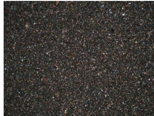
Φωτ. 3.3.14. Τομή B1. Δολερίτης. Εξαιρετικά λεπτόκοκκο με μεγάλο ποσοστό βιοτίτη, επιδότου, κλωρίτη (σκουρόχρωμα- καστανόχρωμα ορυκτά), (α) με N//, (β) με N+.
