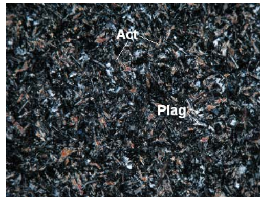
Φωτ. 3.3.8. Τομή Α8. Μετα- Δολερίτης. Χαρακτηριστικοί επιμήκεις κρύσταλλοι πλαγιοκλάστων και ακτινόλιθων, (α) με N//, (β) με N+. Σε αρκετά μικρό ποσοστό διαπιστώθηκαν πιθανές συγκεντρώσεις μεταλλικών ορυκτών.
