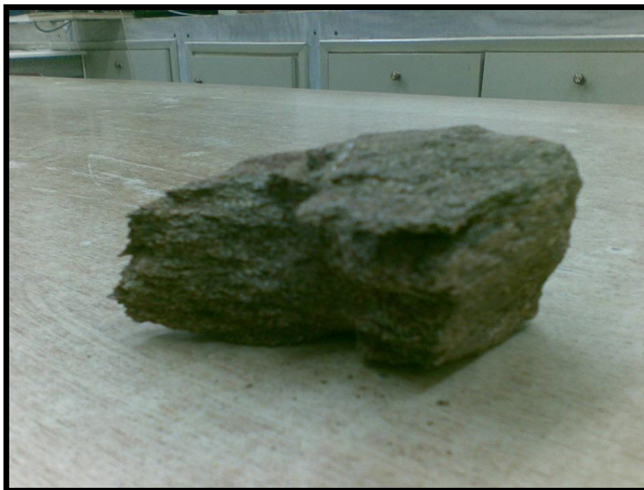
Εικόνα 2.1.10: Υλικό της ενότητας Β (βιοτιτικός γνεύσιος), με έντονη αποσάθρωση βαθμού III-V αλλά διατηρούμενη δομή και υφή
