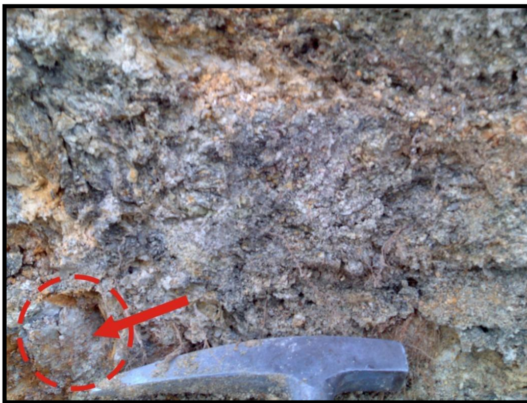
Εικόνα 2.1.11: Υλικό της ενότητας C πλήρως εδαφοποιημένο-αργιλοποιημένο, στο οποίο διατηρούνται «υπολείμματα» ασυνεχειών της βραχομάζας
