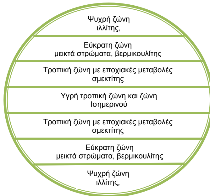
Εικόνα 2.1.1: Επιρροή του παγκόσμιου κλίματος στην ανάπτυξη αργιλικών ορυκτών (Uehara, 1982)
