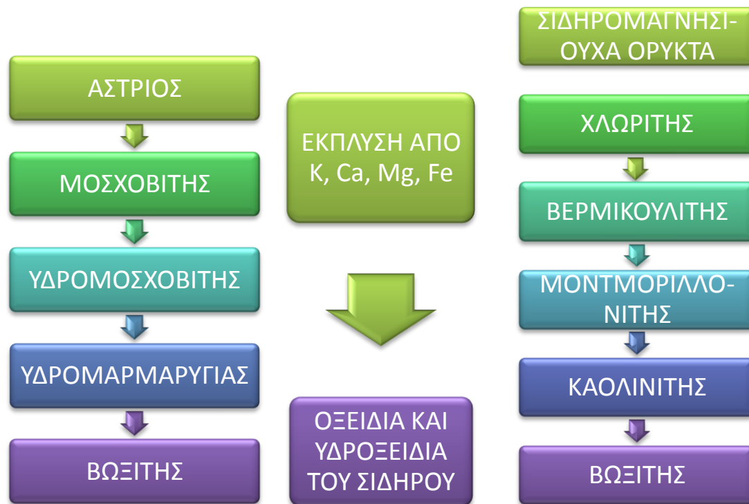
Εικόνα 2.1.4: Προτεινόμενη ακολουθία αποσάθρωσης προς το σχηματισμό αργιλικών ορυκτών (Van der Merwe, 1965)
