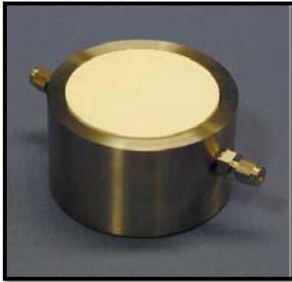
Εικόνα 3.3.7: Κεραμικός δίσκος υψηλής πίεσης εισόδου αέρα (15bar) συνδεδεμένος στη συμβατική βάση τριαξονικής δοκιμής
