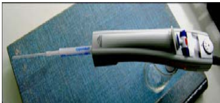
Εικόνα 11. Το σύστημα του ηλεκτρονικού σιφωνίου ( πιπέτας) Eppendorf Multipipette® Stream, με το ρύγχος των 2,5 ml, και την επέκταση. (Αλμπανάκης, 2011).
