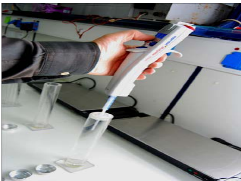
Εικόνα 12. Η πιπέτα σε θέση λήψης δείγματος στον κύλινδρο καθίζησης. (Αλμπανάκης, 2011)
