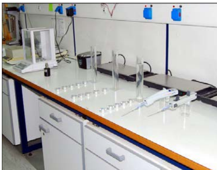
Εικόνα 10. Γενική άποψη του εργαστηρίου, με τους κυλίνδρους καθίζησης, το σιφώνιο Multipette®, τα δοχεία συλλογής των δειγμάτων τον ζυγό και τις θερμαντικές πλάκες. (Αλμπανάκης, 2011)
