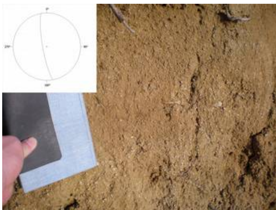
Σχ.29 Επιφάνεια διάρρηξης σε χαλαρά ιζήματα, με γενική διεύθυνση ΒΔΒ-ΝΑΝ και μέτρηση 260/80. Πιθανό ρήγμα ή επιφανειακό φαινόμενο βαρύτητας.
