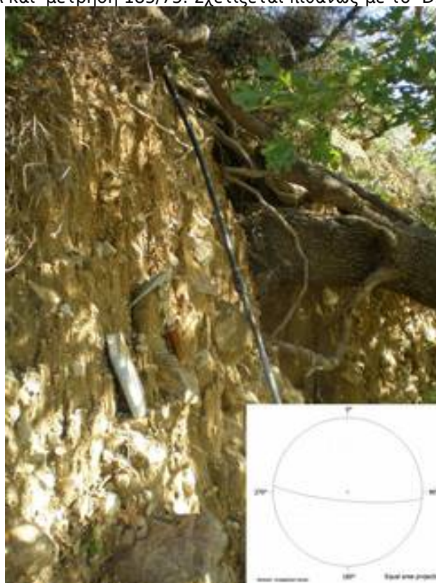
Σχ.42 Πιθανή επιφάνεια Ρήγματος κανονικής μετατόπισης, σε χαλαρά ιζήματα, με γενική διεύθυνση ΔΒΔ-ΑΝΑ και μέτρηση 185/80. Σχετίζεται πιθανώς με το D5 γεγονός.
