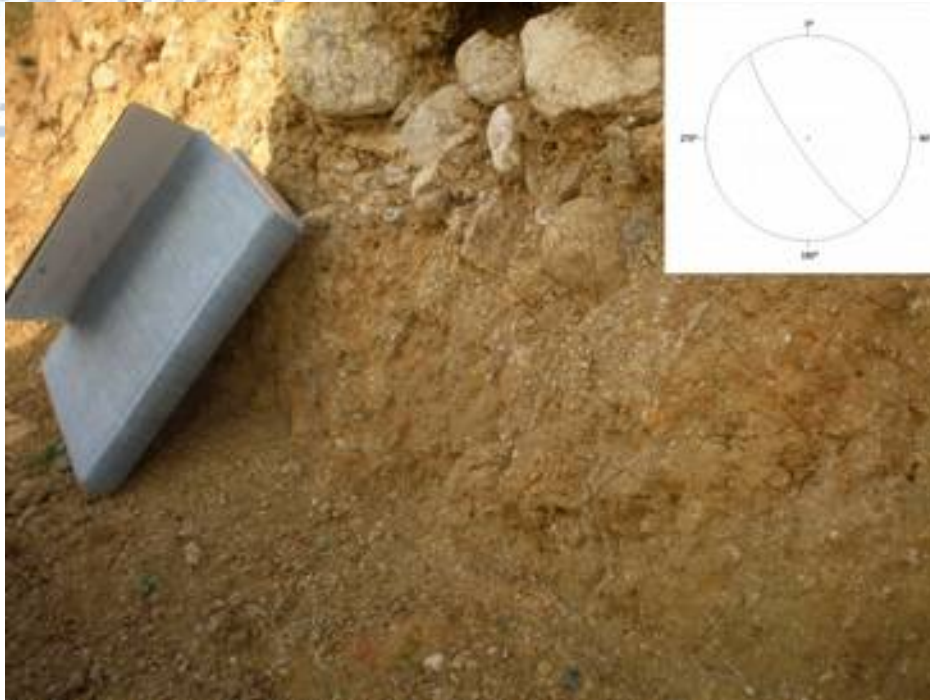
Σχ.30 Πιθανή επιφάνεια Ρήγματος σε χαλαρά ιζήματα, με γενική διεύθυνση ΒΔ-ΝΑ και μέτρηση 235/80.
