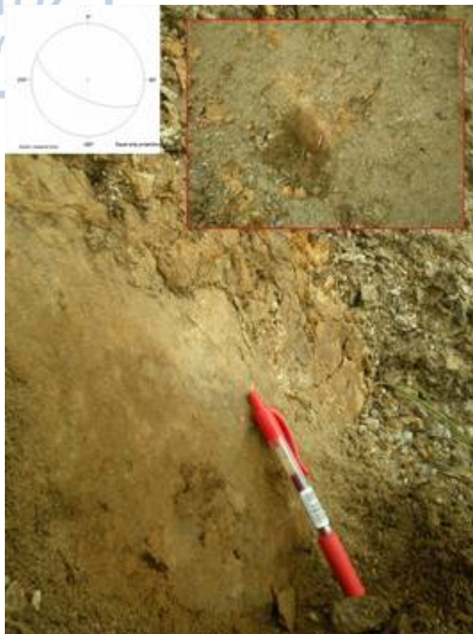
Σχ.26 Επιφάνεια Ρήγματος κανονικής μετατόπισης, σε γνεύσιους, με γενική διεύθυνση ΒΔ-ΝΑ και μέτρηση 205/62 . Σχετίζεται πιθανώς με το D5 γεγονός.
