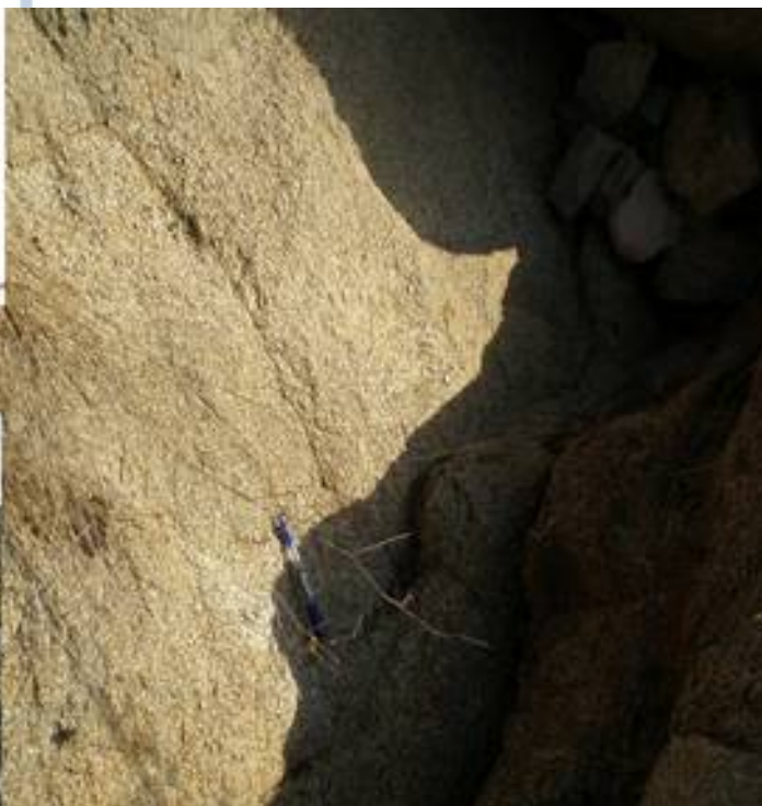
Σχ.37 Επιφάνεια Ρήγματος κανονικής μετατόπισης, σε γρανίτη, με γενική διεύθυνση Δ-Α με μέτρηση 175/85. Σχετίζεται πιθανώς με το D5 γεγονός.
