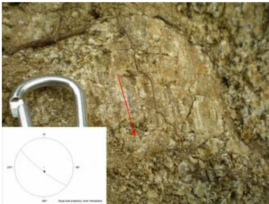
Σχ.27 Επιφάνεια Ρήγματος κανονικής μετατόπισης με γενική διεύθυνση ΒΔ-ΝΑ και μέτρηση 218/80 p80NA.
