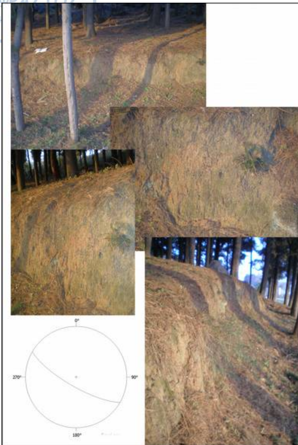
Σχ.34 Πρανές Νεοτεκτονικού Ρήγματος κανονικής μετατόπισης περίπου 80cm, σε χαλαρά ιζήματα, με γενική διεύθυνση ΒΔ-ΝΑ και μέτρηση 210/75. Σχετίζεται πιθανώς με το D5 γεγονός.
