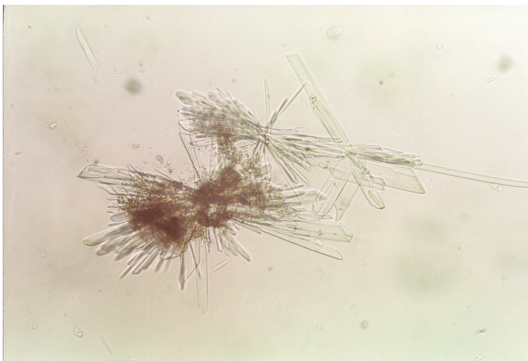
Σχήμα 52. Κρύσταλλοι γύψου, κάτω από το πολωτικό μικροσκόπιο με // Nicols. Μήκος εικόνας 0,56 mm.
