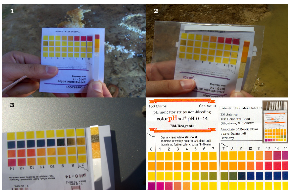
Σχήμα 34. Μέτρηση pH των υδάτων εντός του εργοστασίου εμπλουτισμού (1), στη Λίμνη τελμάτων Αρ. 3 (2) και στον Ποταμό Ειρήνη (3) με την βοήθεια ταινιών μέτρησης pH της εταιρίας Merck-Germany (4).
