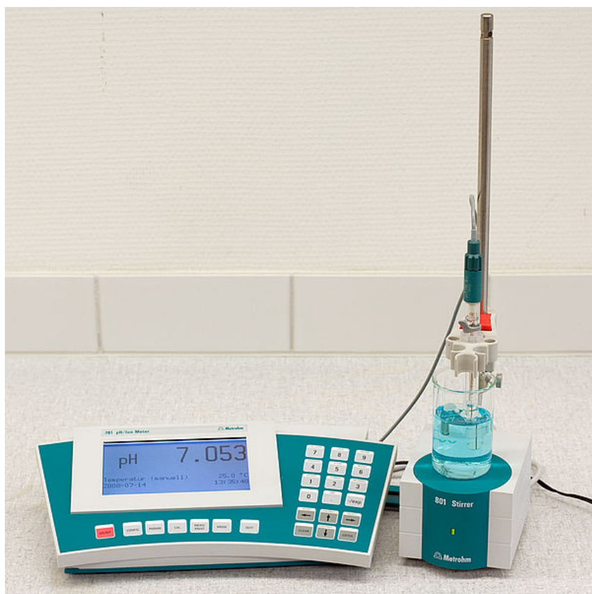
Σχήμα 35. Μεθοδολογία μέτρησης pH: ηλεκτρονικό πεχάμετρο και μαγνητικός αναδευτήρας. Πηγή: http://en.wikipedia.org/wiki/PH_meter .
