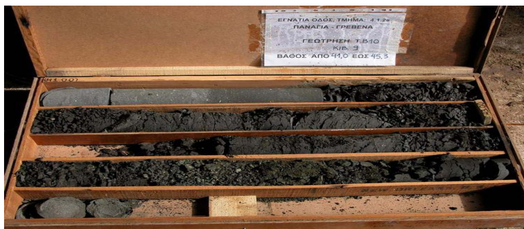
Εικόνα 4.6. Εμφάνιση των ίδιων πυρήνων που εμφανίζεται στην παραπάνω εικόνα αλλά μετά από 6 μήνες στην αποθήκη. Ο ψαμμίτης παραμένει ακέραιος αλλά οι ιλυόλιθοι εμφανίζουν σχάση ακολουθούμενη από κατάρρευση του αρχικού υλικού. (από Β. Μαρίνος, 2007)
