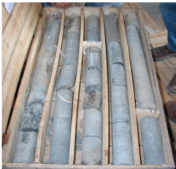
Εικόνα 5.2 Χαρακτηριστική εμφάνιση συμπαγούς δομής με τιμές RQD>60 από πυρήνα δειγματοληψίας σε μέτριο βάθος( ~15m) σε μολασσικά πετρώματα. (από Β. Μαρίνος, 2007)
