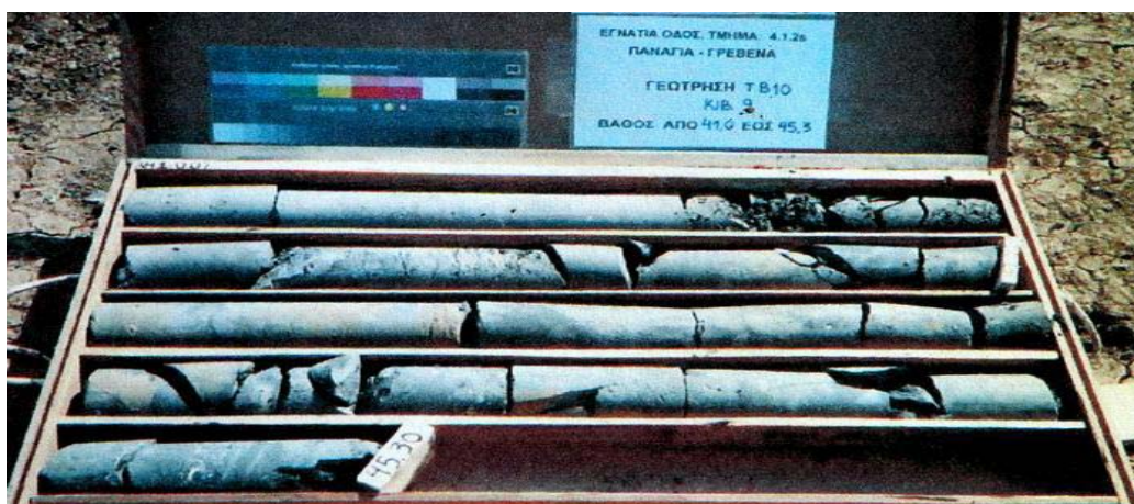
Εικόνα 4.5 Εμφάνιση των πυρήνων γεώτρησης μολασσικού πετρώματος αμέσως μετά την δειγματοληψία. Υπάρχουν ψαμμίτες και ιλυόλιθοι. Το βάθος είναι περίπου 45m. (από Β. Μαρίνος, 2007)
