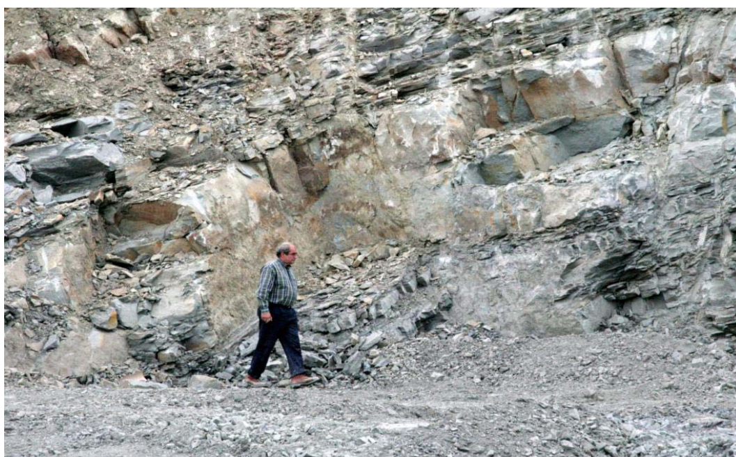
Εικόνα 4.3 Τυπική μορφή παχυστρωματωδών ψαμμιτών με αραιές ενστρώσεις ιλυολίθων σε επιφανειακό σχηματισμό μολάσσας (από Β. Μαρίνος, 2007)
