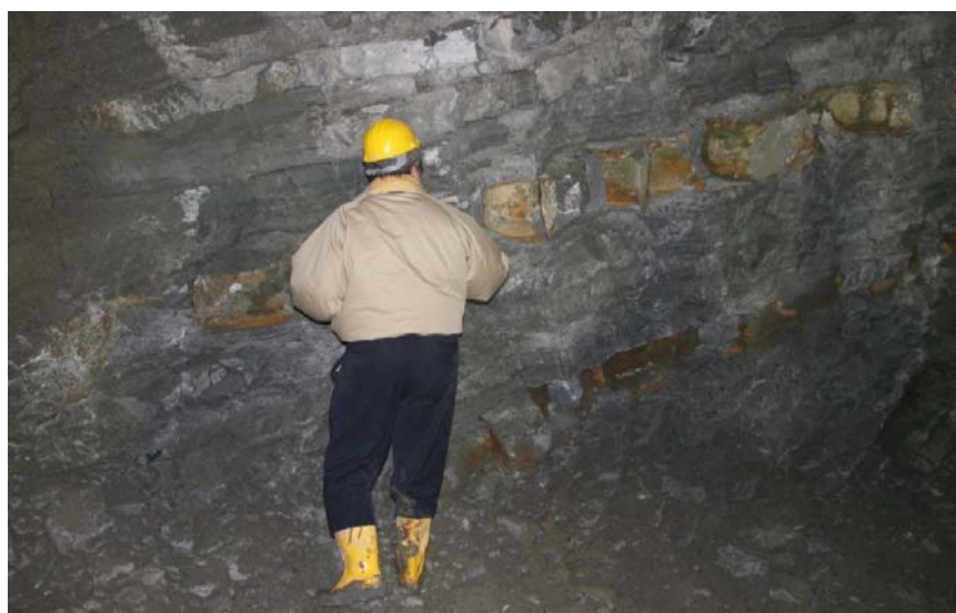
Εικόνα 5.7 Χαρακτηριστική εμφάνιση μολασσικής βραχόμαζας η οποία είναι στρωματώδης και εν μέρει μόνο υπό περιορισμό λόγω μικρού βάθους (άνω περιοχή M2 στο διάγραμμα GSI). GSI=40-45. (από Β. Μαρίνος, 2007).
