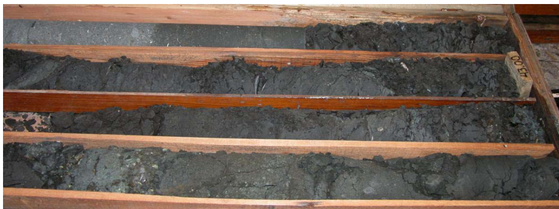
Εικόνα 5.3 Χαρακτηριστική εικόνα άμεσης αλλοίωσης ιλυολιθικών δειγμάτων. (από Β. Μαρίνος, 2007)
