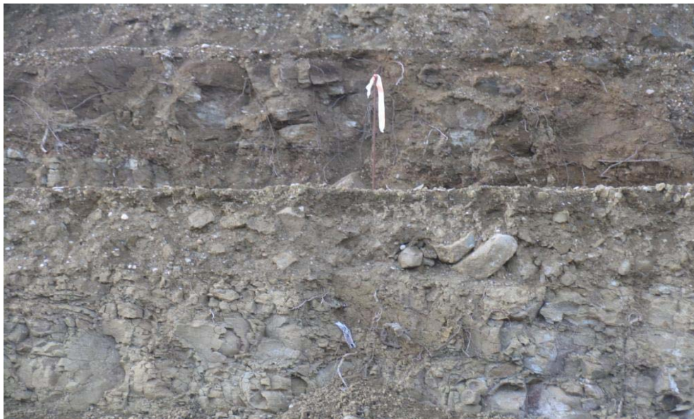
Εικόνα 5.5 Χαρακτηριστική εικόνα εναλλαγών ψαμμίτη και ιλυολίθου με ισομερή παρουσία όπου διακρίνεται η έντονα αποσαθρωμένη δομή στην επιφάνεια (Τύπος III). (από Β. Μαρίνος, 2007)
