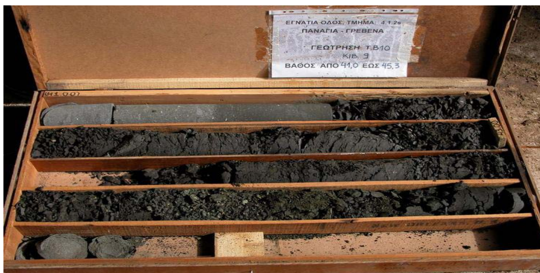
Εικόνα 5.4 Χαρακτηριστική εικόνα σχάσης ιλυολιθικών σχηματισμών σε περιβάλλον μολάσσας. (από Β. Μαρίνος, 2007)
