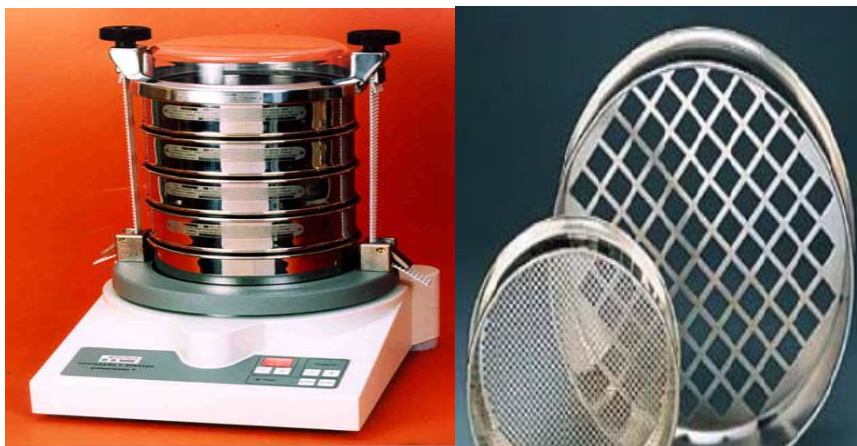
Σχήμα 4.1.1 Συσκευή κοσκινίσματος και κόσκινα
