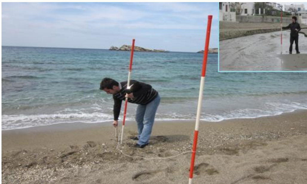
Εικόνα 2.1.1.1 Μετρήσεις με τη μέθοδο των ακοντίων για την κατασκευή μορφολογικού προφίλ.
