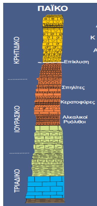
Εικόνα 3.1.6. Στρωματογραφική στήλη Υποζώνης Πάικου
