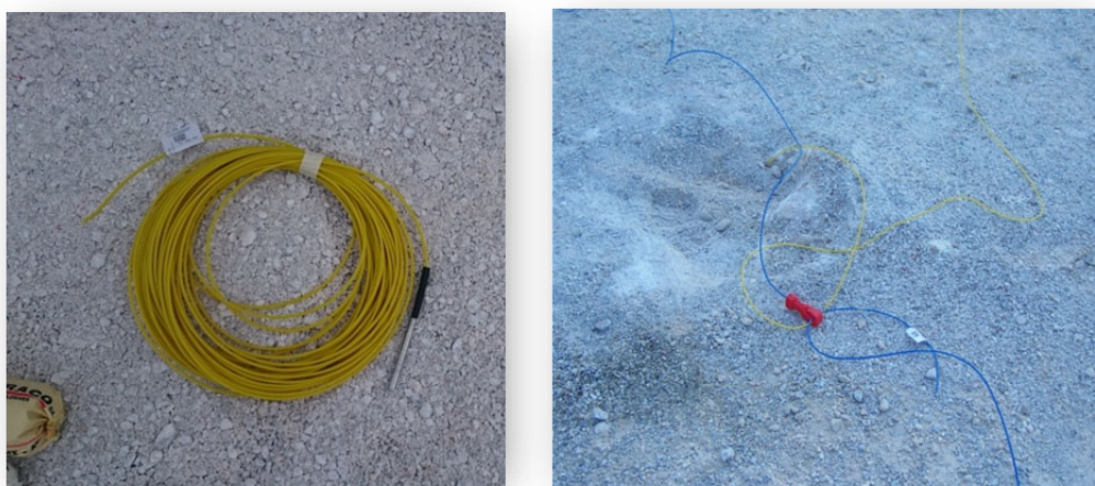
Σχήμα 4.4.5. Μη ηλεκτρικό καψύλι NONEL (αριστερά) και σύνδεση NONEL με συνδετήριο καψυλίου (δεξιά).
