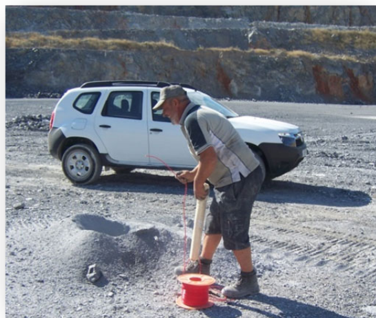
Σχήμα 9.2.11. Το φυσίγγιο αμμωνίτη με την ακαριαία θρυαλλίδα.
