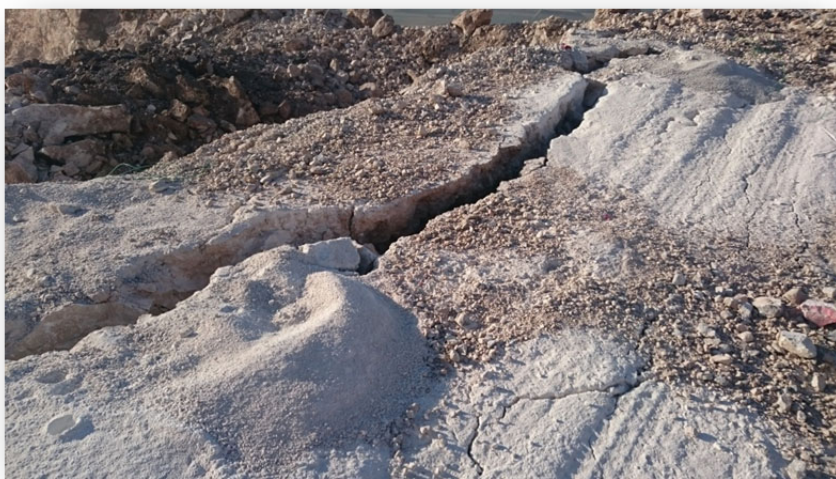
Σχήμα 4.2.3. Η ρωγμάτωση (backbreak) πίσω από την τελευταία σειρά διατρημάτων.
