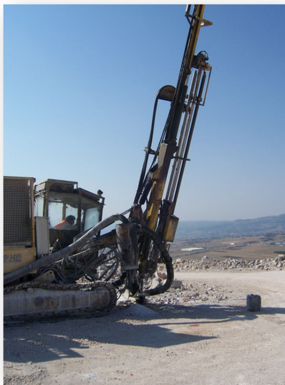
Σχήμα 4.2.1. Διαδικασία της διάτρησης στο μέτωπο της ανατίναξης.
