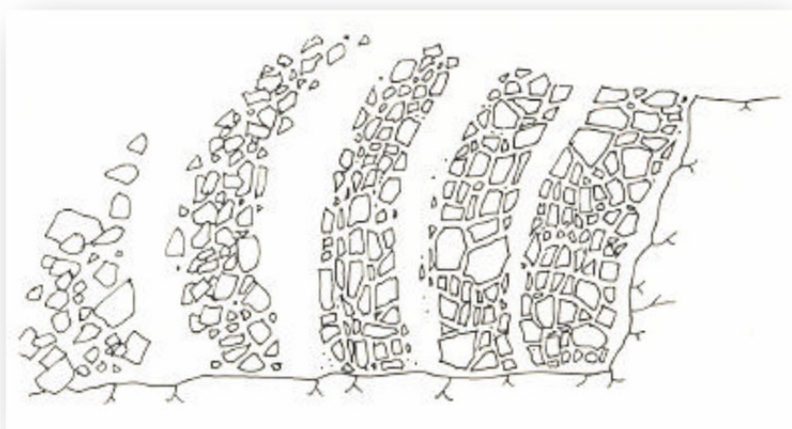
Σχήμα 4.3.3. Πολύ μεγάλα χρονικά διαστήματα έναυσης μεταξύ των διατρημάτων (Surface Blasting Handbook 2014).
