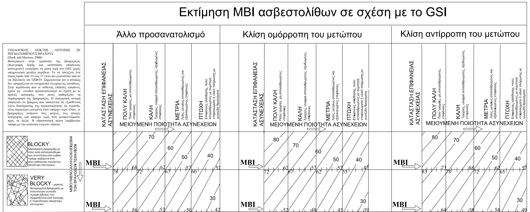
Σχήμα 9.2.23. Διάγραμμα εκτίμησης του τροποποιημένου Δείκτη εκρηκτικής ικανότητας (MBI) των ασβεστολίθων με τεμαχώδη και πολύ τεμαχώδη δομή μέσω του Γεωλογικού δείκτη αντοχής (GSI). Διακρίνονται τρεις περιπτώσεις ανάλογα με τον προσανατολισμό του κύριου συστήματος ασυνεχειών ως προς το μέτωπο της εξόρυξης.
