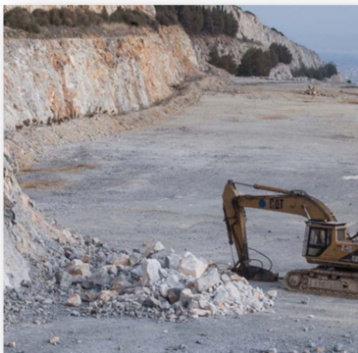
Σχήμα 8.2.2. Οι ογκόλιθοι και το υδραυλικό σφυρί θραύσης τους.
