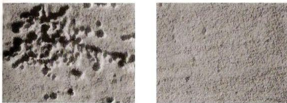
Εικόνα 4.1. Αριστερά: διάβρωση με βελονισμούς ≡ κυψελοειδής φθορά. Δεξιά: διάβρωση με βελονισμούς ≡ ζαχαροειδής φθορά (Σκουλικίδης, 2000)
