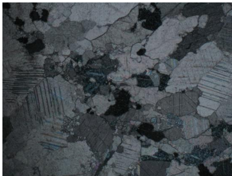
Εικόνα 8.1.18. Φωτομικρογραφία πολωτικού μικροσκοπίου (+N), Αλλοτριόμορφος ιστός και με ασθενή επιμήκυνση
