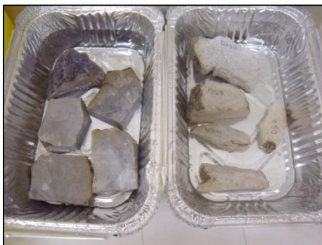
Εικόνα 7.12. Δείγματα πλήρως βυθισμένα σε απιονισμένο νερό για τις μετρήσεις υδαταπορρόφησης
