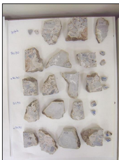
Εικόνα 7.11. Προετοιμασία δειγμάτων για επίστρωση με πολυμερικά επιστρώματα
