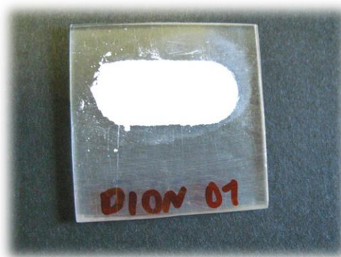
Εικόνα 7.8. Πλαστικό πλακίδιο με κονιορτοποιημένο δείγμα για τη μελέτη με περιθλασιμετρία ακτίνων Χ
