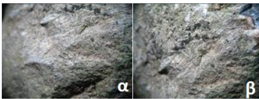
Εικόνα 8.1.16. Δευτερογενής ορυκτολογική σύσταση του δείγματος DD3 α, β. Εξωτερική πλευρά, φωτογραφία σε στερεομικροσκόπιο
