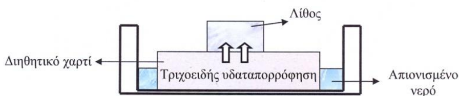
Σχέδιο 6.1. Σχηματική αναπαράσταση της πειραματικής διάταξης τριχοειδούς υδαταπορρόφησης του λίθου (Μανούδης, 2009)
