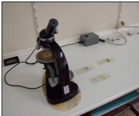
Εικόνα 7.7. Οπτικό πολωτικό μικροσκόπιο και λεπτές τομές δειγμάτων σε αντικειμενοφόρους πλάκες
