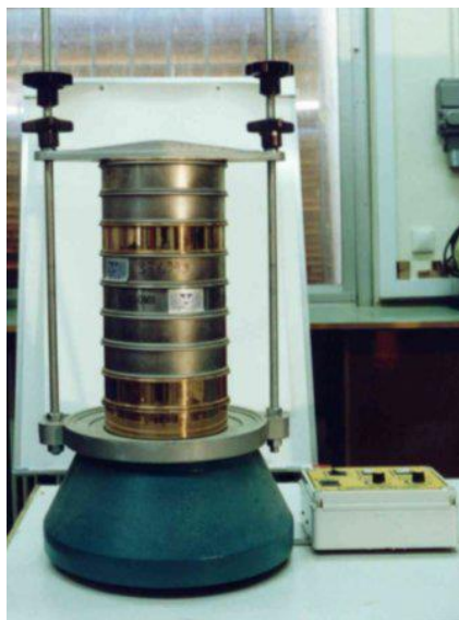
Εικόνα 6.3. Διάταξη κοκκομετρικής δοκιμής (Σακελλαρίου et al., 2003)
