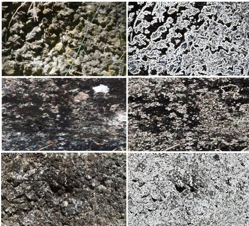
Εικόνα 8.2.15. Χαρακτηριστικές εικόνες των επιφανειών των δομικών λίθων μετά την εφαρμογή του τελεστή Sobel (Sobel edge detector). Τα μαύρα σημεία είναι επικαλυμμένα με προϊόντα διάβρωσης.
