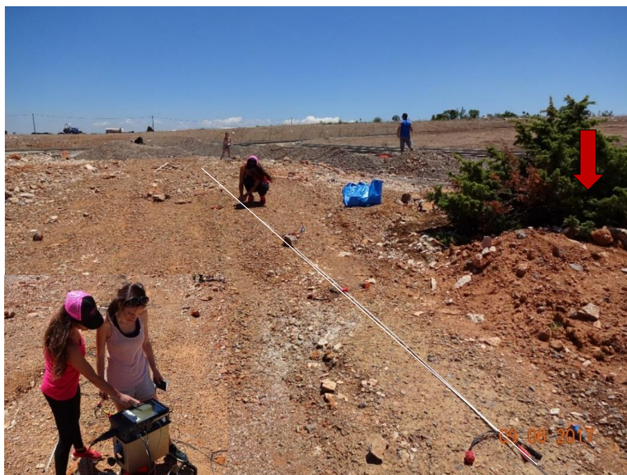
Σχήμα 5.20 Εκτέλεση σεισμικού πειράματος κατά μήκος του προφίλ L3 και όργανο καταγραφής STRATAVIEW. Το κόκκινο βέλος αντιστοιχεί στο κενό.
