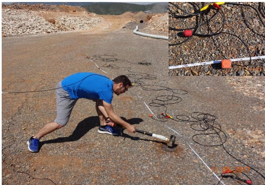
Σχήμα 5.10 Εκτέλεση σεισμικού πειράματος MASW κατά μήκος του προφίλ L1 με γεώφωνα ιδιοσυχνότητας 4.5 Hz και σφυρί 10 kg ως πηγή επιφανειακών κυμάτων.
