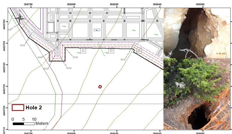
Σχήμα 5.17 Εντοπισμός εγκοίλου στο χώρο στάθμευσης ΝΑ του κτηρίου Γ.
