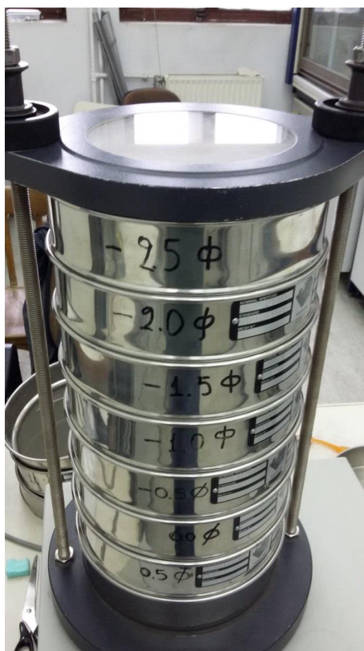
Εικόνα 2.2.1 παρατηρούνται τα κόσκινα στο μηχάνημα ανάδευσης.
