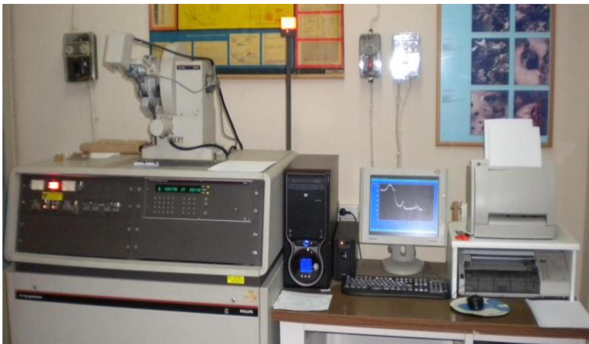
Εικόνα 3. Περιθλασίμετρο ακτίνων-Χ του Τμήματος Γεωλογίας του Α.Π.Θ.
