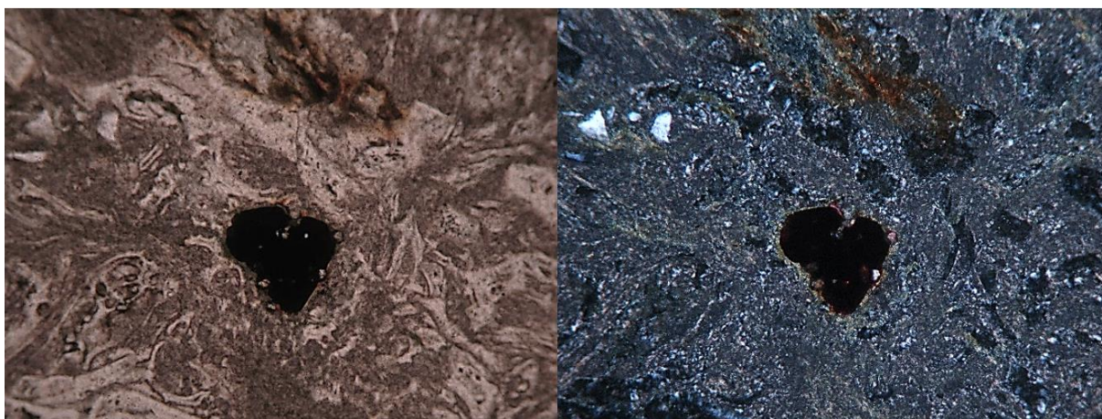
Εικόνα 18. Εξαλλοιωμένος βιοτίτης, N// , μεγέθυνση 10x.
