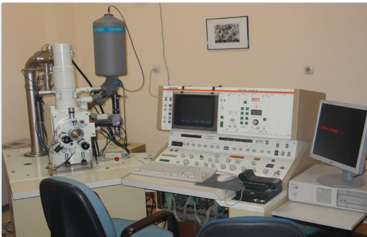
Εικόνα 4. Σαρωτικό ηλεκτρονικό μικροσκόπιο (SEM) του Α.Π.Θ.
