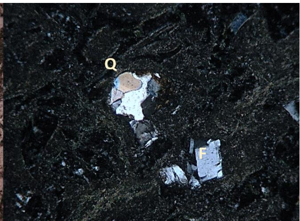
Εικόνα 17. Πολυκρυσταλλικός χαλαζίας (Q), Άστριος (F), N⊥, μεγέθυνση 10x.
