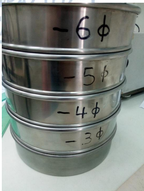
Εικόνα 14: Κόσκινα κλίμακας -6Φ έως -3Φ
