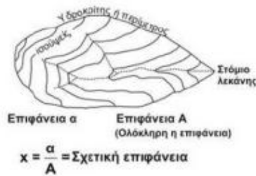
Σχήμα 12: Παράδειγμα υψομετρικού ολοκληρώματος. Υπολογισμός παραμέτρων x, y στα αριστερά, διάγραμμα απεικόνισης υψομετρικού ολοκληρώματος στα δεξιά (Μορφομετρικές Παράμετροι Λεκάνων Απορροής)
