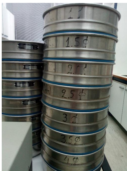
Εικόνα 15: Κόσκινα κλίμακας 1Φ έως 4Φ
