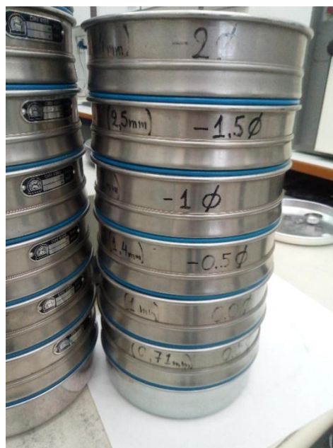
Εικόνα 13: Κόσκινα κλίμακας -2Φ έως 0,5Φ
