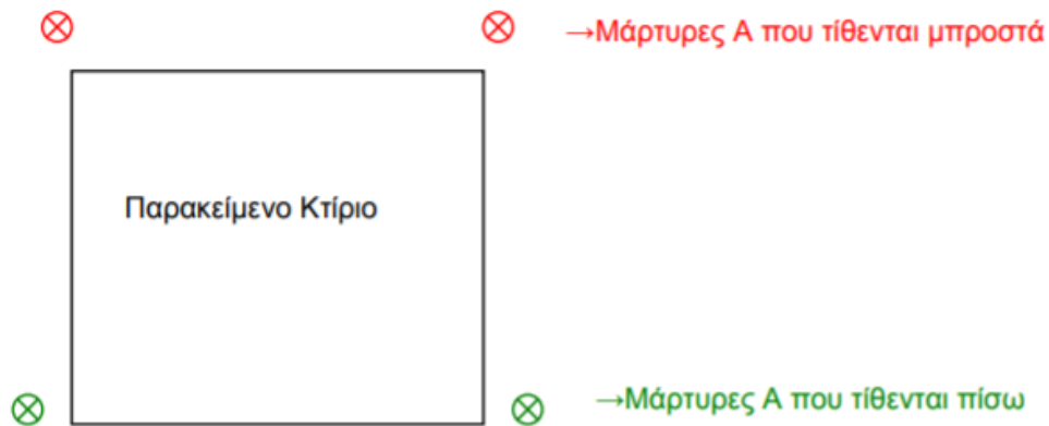
Σχήμα 5.5: Σχεδιάγραμμα τοποθέτησης μαρτύρων παρακολούθησης μετακινήσεων περιμετρικά κατασκευών.
