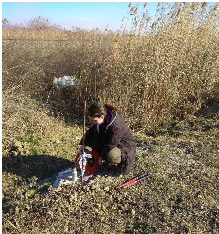
Εικόνα 2 : Μέτρηση στάθμης του υδροφορέα.
