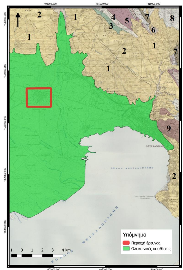
Σχήμα 2.2.3 : Γεωλογικός χάρτης της περιοχής έρευνας (Φύλλο I.Γ.Μ.Ε. 1:50.000 Θεσσαλονίκης). Με το πράσινο χρώμα οριοθετούνται οι ολοκαινικές αποθέσεις, ενώ με το κόκκινο οριοθετείτε η περιοχή έρευνας. [1: Σειρά ερυθρών αργίλων, 2: Ψαμμιτομαργαϊκή σειρά, 3: Φυλλιτικοί σχιστόλιθοι, 4: Κροκαλοπαγή, 5: Γάββρος, 6: Αποθέσεις αναβαθμίδας (άμμοι, μάργες, ασβεστόλιθοι), 7: Γνεύσιος, 8: Ψαμμίτες, 9: Σχιστόλιθοι] (Τρανός Μ., 2016)
