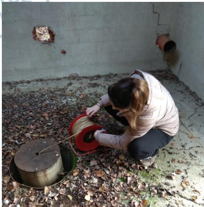
Εικόνα 1 : Μέτρηση στάθμης του υδροφορέα.
