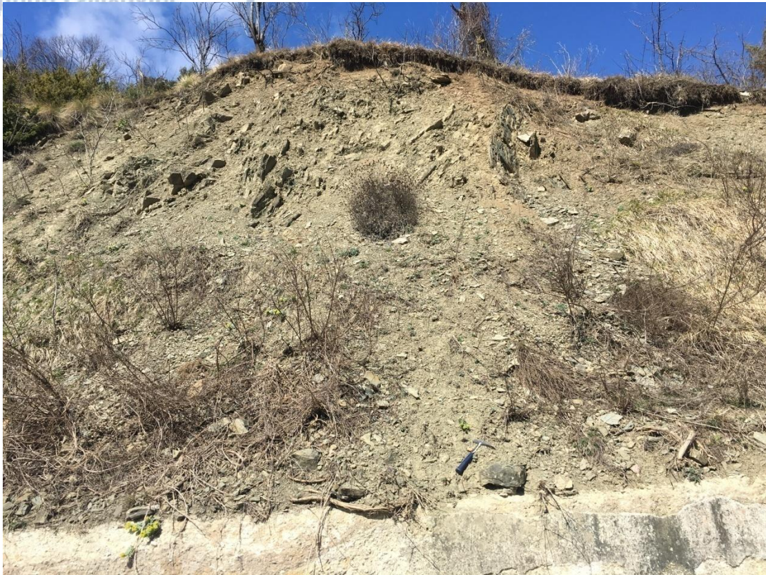
Εικόνα 5.24 Εμφάνιση έντονα διαταραγμένου ανοικτού καφέ ιλυολιθικού φλύσχη. Τοπικά εμφανίζονται αποσαθρωμένα τεμάχια ψαμμίτη.
