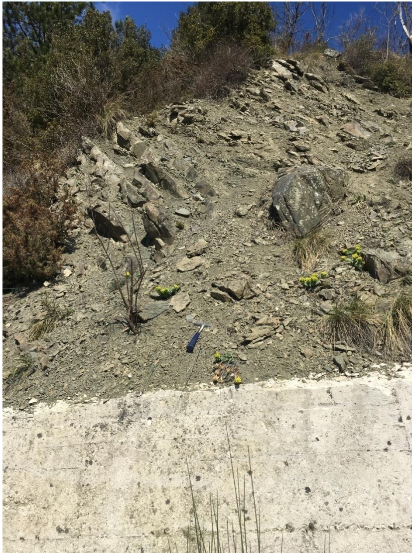
Εικόνα 5.26 Δεύτερη εμφάνιση φλύσχη ιλιολιθικού φλύσχη χρώματος ανοικτό γκρι έντονα διαταραγμένου. Ο ψσμίτης σε αυτή τη περίπτωση εμφανίζεται με μικρά πολύ αποσαθρωμένα και φυλλοποιημένα τεμάχια ή τοπικά με μεγαλύτερα και επίσης αποσαθρωμένα
