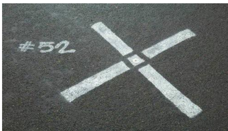
Εικόνα 3.11 Τεχνητά σημεία εδάφους για ακρίβεια τοποθεσίας (blog.dronedeploy.com)
