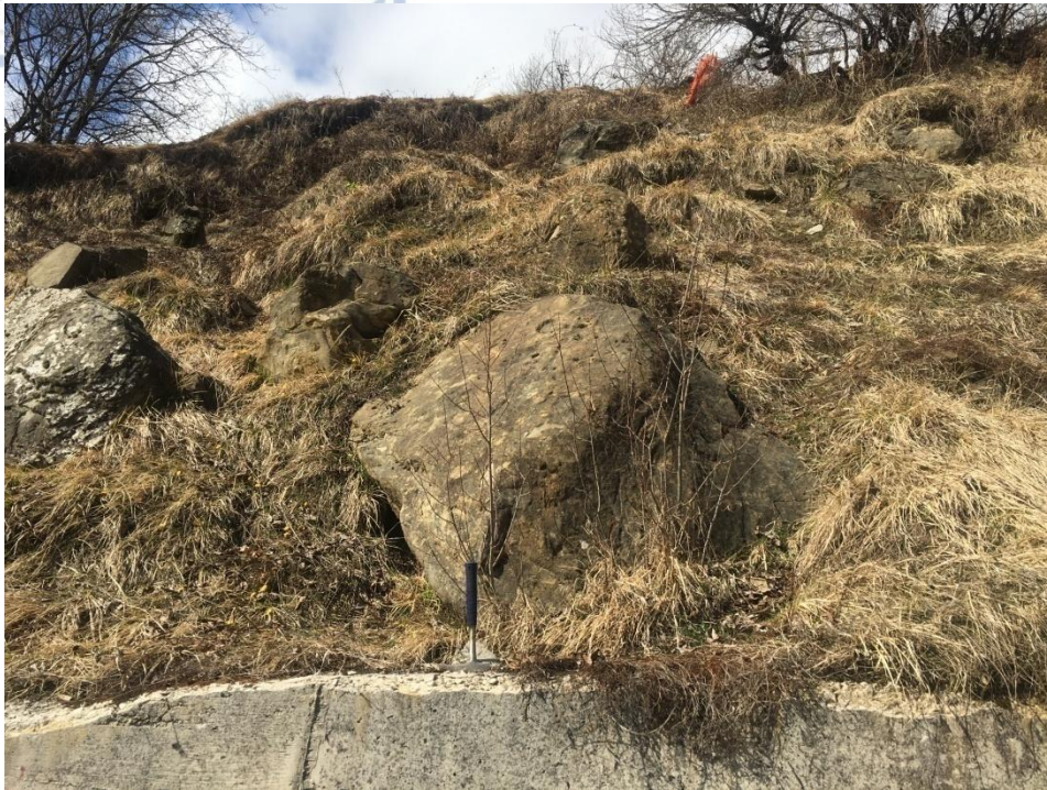
Εικόνα 5.12 Μεγάλα τεμάχη ψαμμίτη που ολισθαίνουν
