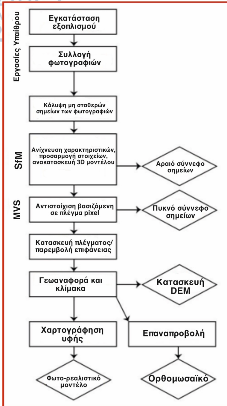
Σχήμα 2. Διάγραμμα ροής όπου παρουσιάζεται μία τυπική μεθοδολογία φωτογραμμετρίας Bemis et al., (2014), τροποποιημένο.
