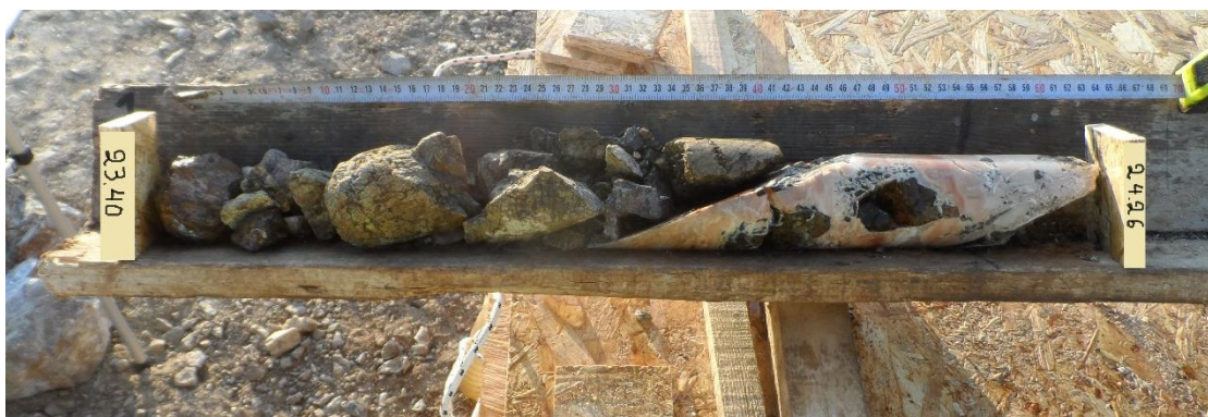
Εικόνα 7.1.24: Σχηματισμός τύπου Breccia και κερματισμένος σερπεντινωμένος δουνίτης μέσα στην ζώνη του ρήγματος ΕΛΛΗΜΕΤ 2018).
