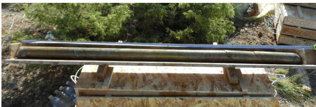
Εικόνα 7.1.13: Συμπαγής, ελαφρώς σερπεντινωμένος, ελαιοπράσινος δουνίτης με διάσπαρτο χρωμίτη (ΕΛΛΗΜΕΤ 2018).
