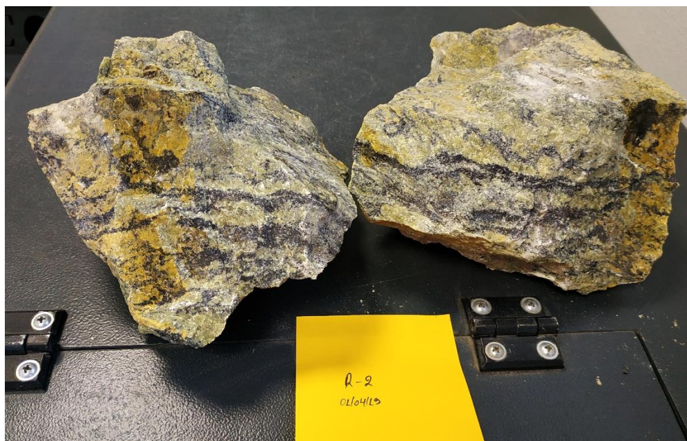
Εικόνα 7.3.2: Δείγμα χρωμίτη με κονδύλους δουνίτη (R-003) (ΕΛΛΗΜΕΤ 2019).
