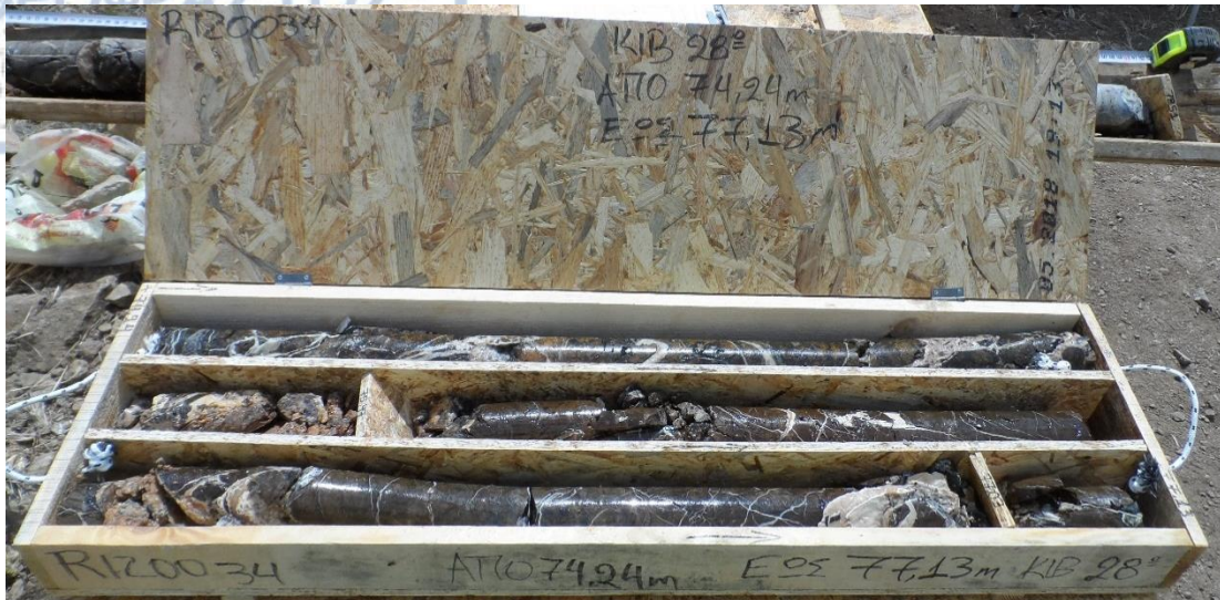
Εικόνα 7.1.6: Πυρήνες στους οποίους διακρίνεται ο εξαλλοιωμένος, οξειδωμένος δουνίτης με φλέβες οπαλλίου και εμφάνιση Breccia (ΕΛΛΗΜΕΤ 2018).
