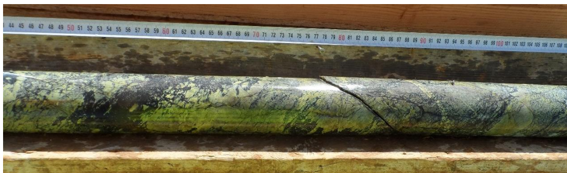
Εικόνα 7.1.17: Συγκέντρωση χρωμίτη μέσα στον δουνίτη σε βάθος 84.18 μέτρα (ΕΛΛΗΜΕΤ 2018).
