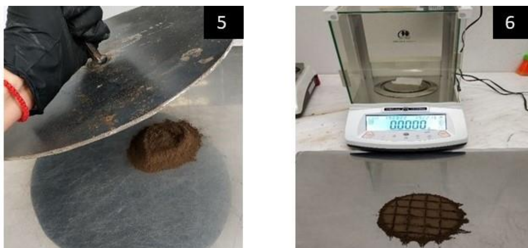
Εικόνα 6.5.1.: (6.5.1.5) και (6.5.1.6) δείγμα <0.2 mm που εφαρμόζεται η μέθοδος τετραμερισμού για την λήψη του δείγματος, (ΕΛΛΗΜΕΤ 2019)
