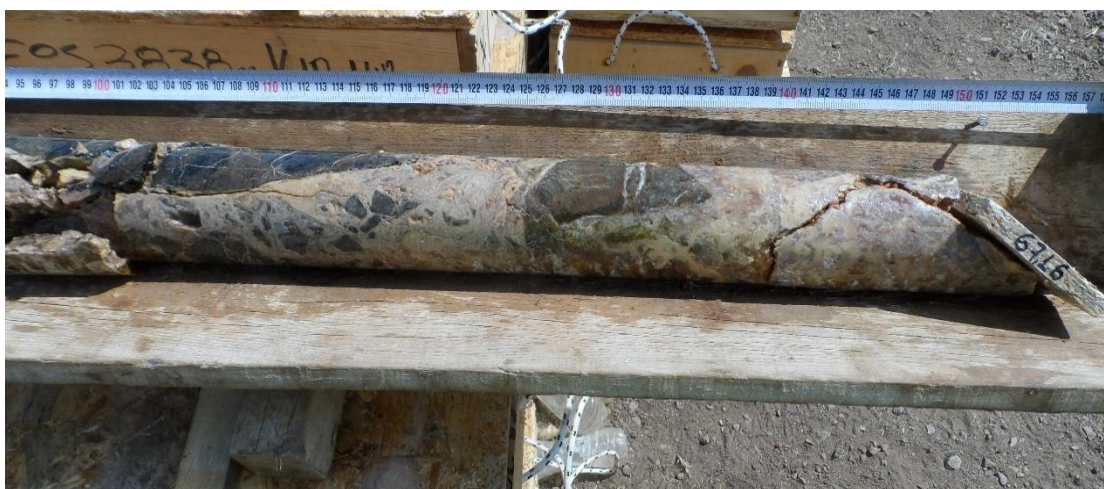
Εικόνα 7.1.4: Αρχή ρηξιγενούς ζώνης, παρουσία Breccia σε βάθος 66.62-67.16 μέτρα (ΕΛΛΗΜΕΤ 2018).
