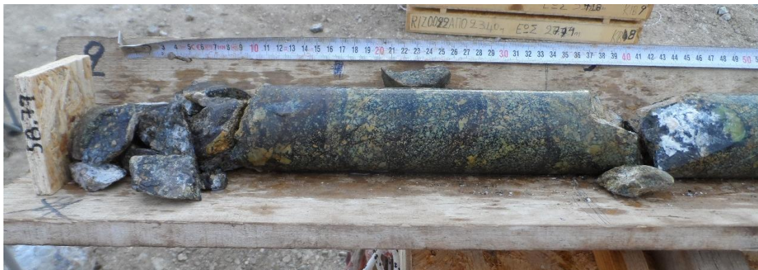
Εικόνα 7.1.26: Μεγάλη συγκέντρωση διάσπαρτου χρωμίτη μέσα στον εξαλλοιωμένο δουνίτη (ΕΛΛΗΜΕΤ 2018).
