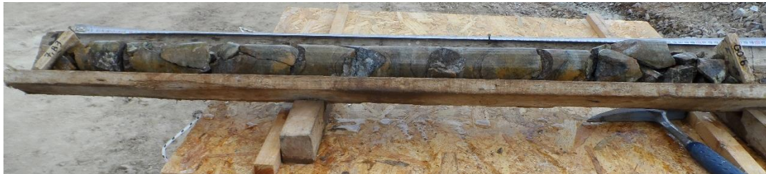
Εικόνα 7.1.22: Τυπική εικόνα ρηγματωμένου δουνίτη για τα πρώτα μέτρα της γεώτρησης (ΕΛΛΗΜΕΤ 2018).
