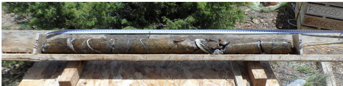
Εικόνα 7.1.15: Εξαλλοιωμένος δουνίτης με στρώσεις οπαλλίου και φλέβα πυροξένου σε βάθος 56 έως 56.10 μέτρα (ΕΛΛΗΜΕΤ 2018).
