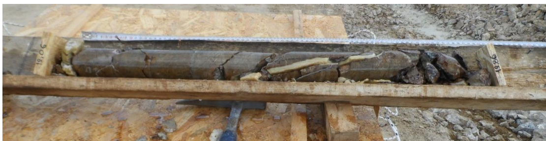
Εικόνα 7.1.23: Χαρακτηριστική ανάπτυξη οπαλλίου μέσα στο ρήγμα που «κόβει» τον δουνίτη (ΕΛΛΗΜΕΤ 2018).
