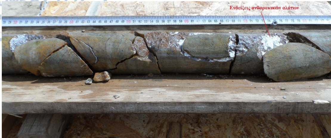
Εικόνα 7.1.21: Σχηματισμός ανθρακικών αλάτων μέσα στον ρηγματωμένο δουνίτη (ΕΛΛΗΜΕΤ 2018).
