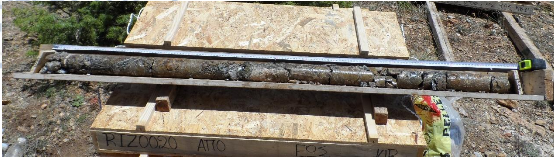
Εικόνα 7.1.9.: Χαρακτηριστική εμφάνιση δουνίτη σερπεντινωμένου, οξειδωμένου, ρηγματωμένου με διάσπαρτους κόκκους χρωμίτη και οπάλλιο στις διακλάσεις (ΕΛΛΗΜΕΤ 2018).
