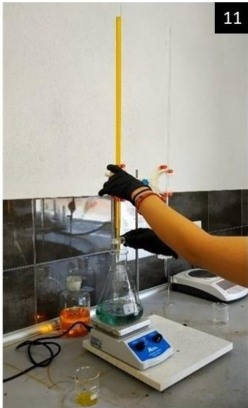
Εικόνα 6.5.1.: Τελικό στάδιο μέτρησης για τον υπολογισμό περιεκτικότητας σε \text{Cr}_2\text{O}_3 . (ΕΛΛΗΜΕΤ 2019)
