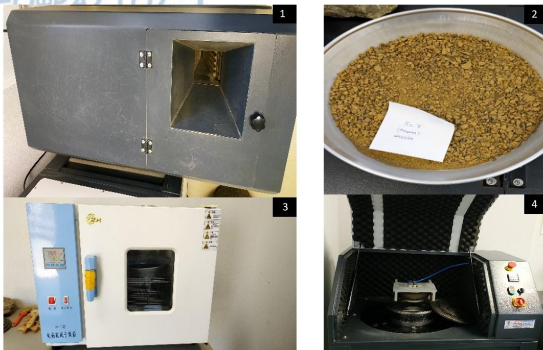
Εικόνα 6.5.1.: Φωτογραφίες από την διαδικασία της τιτλοδότησης (6.5.1.1) Σπαστήρας που χρησιμοποιείται στο 1 ο βήμα, (6.5.1.2) ποσότητα δείγματος 1 mm που προέκυψε με την μέθοδο τετραμερισμού, (6.5.1.3) Ειδικός ξηραντήρας που χρησιμοποιείται στο 3 ο βήμα, (6.5.1.4) Pulveriser για το 4 ο βήμα (ΕΛΛΗΜΕΤ 2019)
