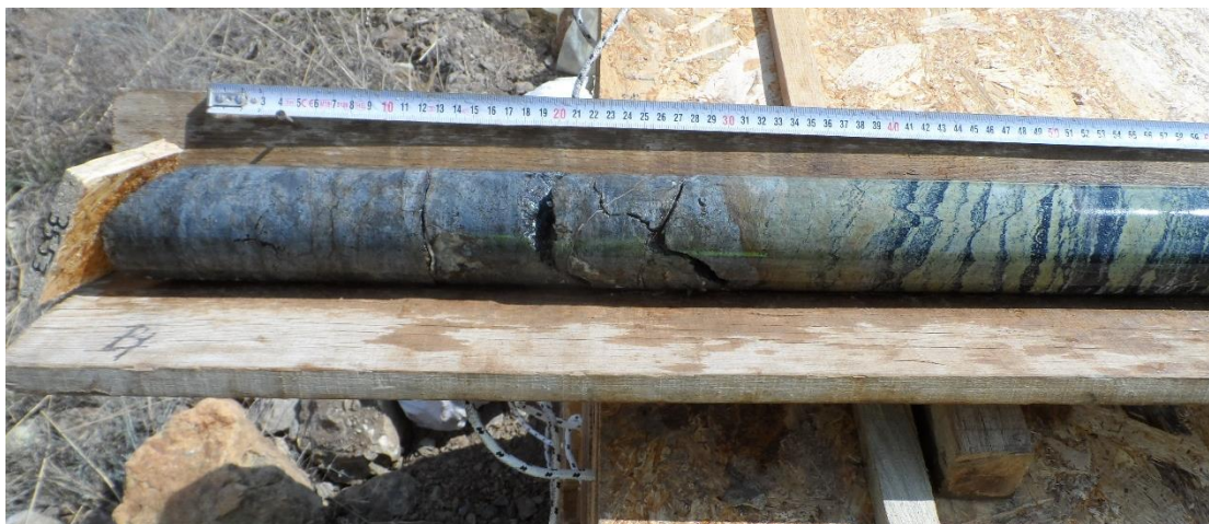
Εικόνα 7.1.2: Μετάβαση από Πυροξενίτη σε Δουνίτη με Χρωμίτη τύπου Schlieren (ΕΛΛΗΜΕΤ 2018)
