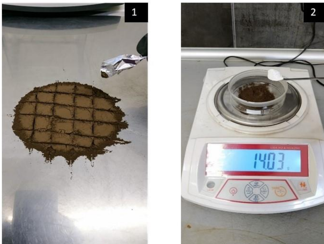
Εικόνα 6.6.1: Φωτογραφίες από την διαδικασία της μέτρησης με XRF από το 5 ο βήμα και μετά (6.6.1.1) Διαδικασία τετραμερισμού και λήψη απαραίτητης ποσότητας δείγματος, (6.6.1.2) προσθήκη συγκολλητικής ουσίας (ΕΛΛΗΜΕΤ 2019)
