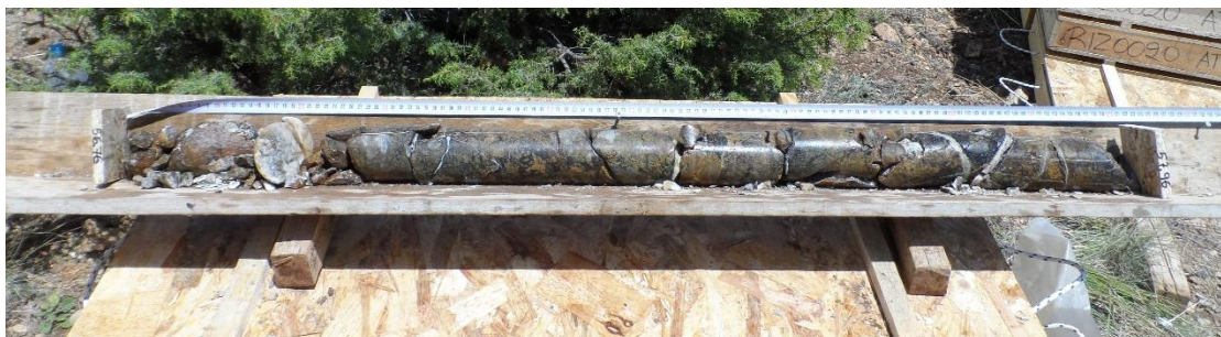
Εικόνα 7.1.16: Συγκέντρωση διάσπαρτου χρωμίτη μέσα σε εξαλλοιωμένο δουνίτη με παρουσία οπαλλίου (ΕΛΛΗΜΕΤ 2018).
