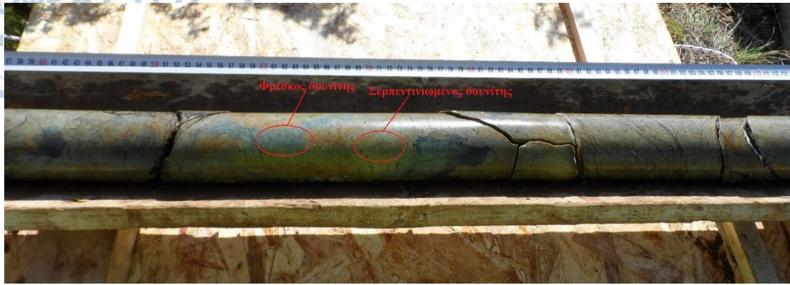
Εικόνα 7.1.14: Εναλλαγές σερπεντινωμένου και φρέσκου δουνίτη με διάσπαρτο χρωμίτη (ΕΛΛΗΜΕΤ 2018).
