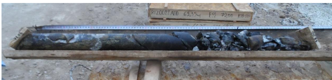
Εικόνα 7.1.29: Χρωμιτούχος δουνίτης σε βάθος 73.06- 74.00 μέτρα (ΕΛΛΗΜΕΤ 2018).
