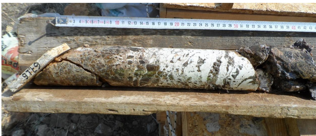
Εικόνα 7.1.5: Συνέχεια Breccia και λευκόλιθος σε βάθος 67.16-67.60 μέτρα (ΕΛΛΗΜΕΤ 2018).
