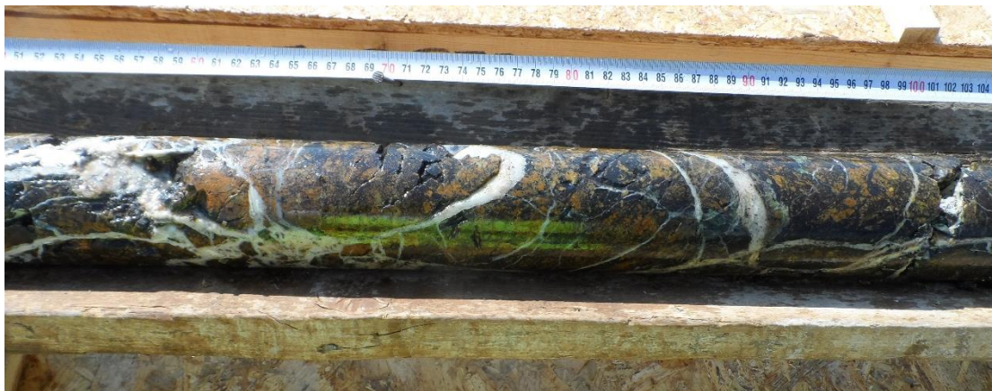
Εικόνα 7.1.7: Συγκεντρώσεις χρωμίτη μέσα σε εξαλλοιωμένο δουνίτη με φλέβες οπαλλίου, σε βάθος 74.51-75.06 (ΕΛΛΗΜΕΤ 2018).
