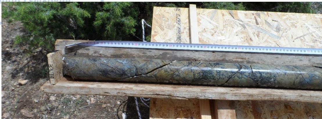
Εικόνα 7.1.12: Εμφανίσεις χρωμίτη μέσα σε συμπαγή σερπεντινωμένο δουνίτη (ΕΛΛΗΜΕΤ 2018).
