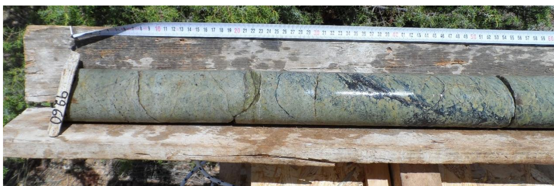
Εικόνα 7.1.18 : Τυπική εικόνα δουνίτη συμπαγούς με μεγάλη συγκέντρωση διάσπαρτου χρωμίτη σε βάθος 92.60-93.21 μέτρα (ΕΛΛΗΜΕΤ 2018).
