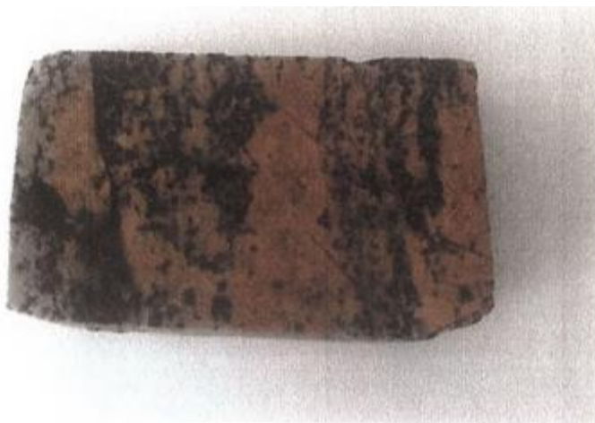
Εικόνα 7.2.1: Ταινιωτός χρωμίτης μέσα σε σερπεντινωμένο δουνίτη, δείγμα 5. (ΕΛΛΗΜΕΤ 2018)
