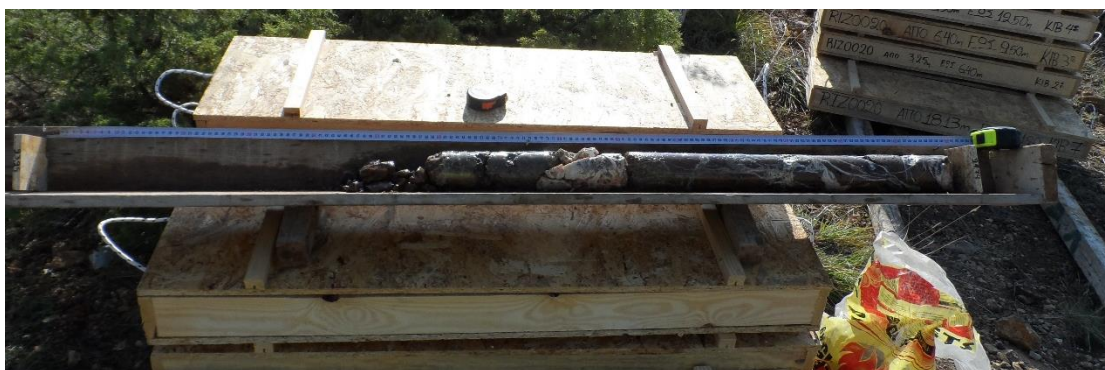
Εικόνα 7.1.11: Έλλειψη δείγματος από 20 η βουτιά σε βάθος 23.25 έως 23.85 μέτρα (ΕΛΛΗΜΕΤ 2018).
