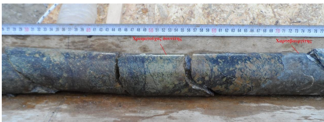
Εικόνα 7.1.27: Εναλλαγή χρωμιτούχου δουνίτη με χαρτσβουργίτη στα 62.75 μέτρα (ΕΛΛΗΜΕΤ 2018).
