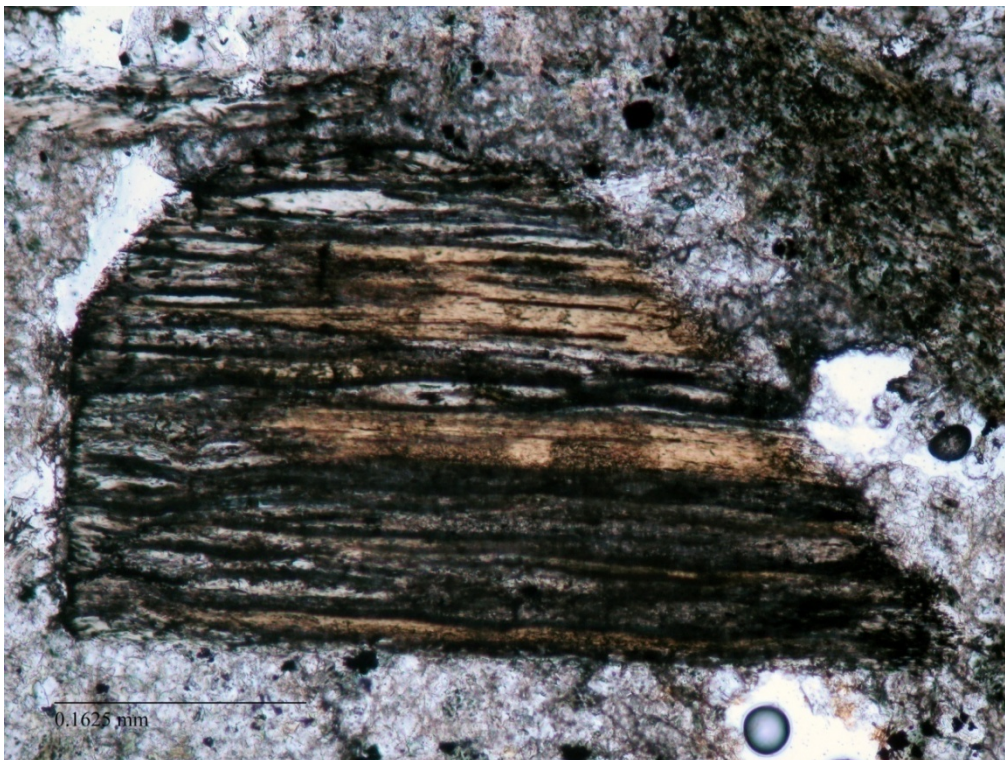
Σχήμα 5.8. Φωτογραφία της τομής του δείγματος Ger12b με πολωτή και με πολωτή και αναλυτή, όπου είναι ορατή η αλλοίωση του μαγματικού βιοτίτη σε χλωρίτη.
