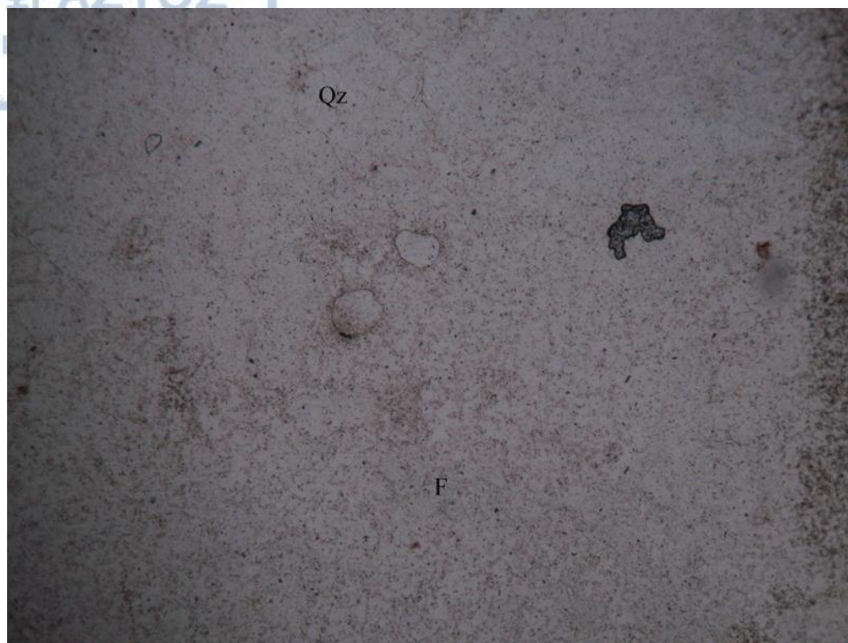
Εικ. 5.2.7. Μικροσκοπική εικόνα μόνο με πολωτή του δείγματος RZN6. Διακρίνονται χαλαζίας (Qz) και άστριοι (F). Μήκος φωτογραφίας = 2.6 mm.
