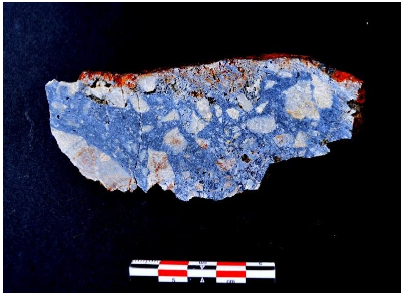
Εικ. 5.3.10. Μακροσκοπική εικόνα του δείγματος RZN7. Διακρίνονται κλάστες εξαλλοιωμένου γνευσίου και μεταλλοφορία αντιμονίτη πλήρωσης κενών.
