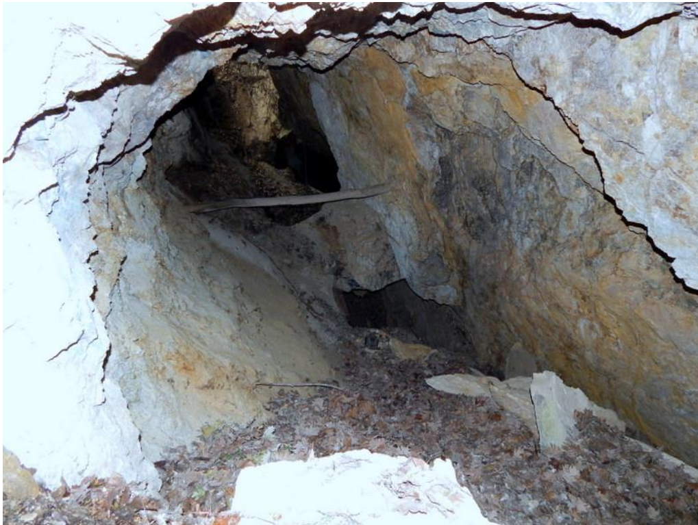
Εικ. 3.2.6. Στοές που κόβουν ρήγμα όπου εμφανίζεται η μεταλλοφορία στα Ριζανά. Διάνοιγμα πολλαπλών επιπέδων που ακολουθούν την μεταλλοφορία.
