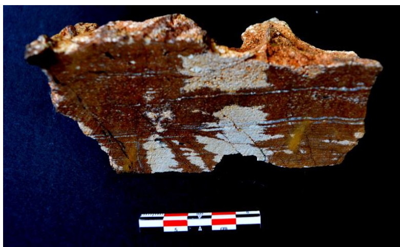
Εικ.5.1.4. Δείγμα RZN8. Ο γνεύσιος έχει υποστεί σχεδόν ολοκληρωτική οξείδωση και υδροθερμική εξαλλοίωση. Διακρίνονται κάποια φλεβίδια χαλαζία που διεισδύουν παράλληλα προς την σχιστότητα του γνευσίου.
