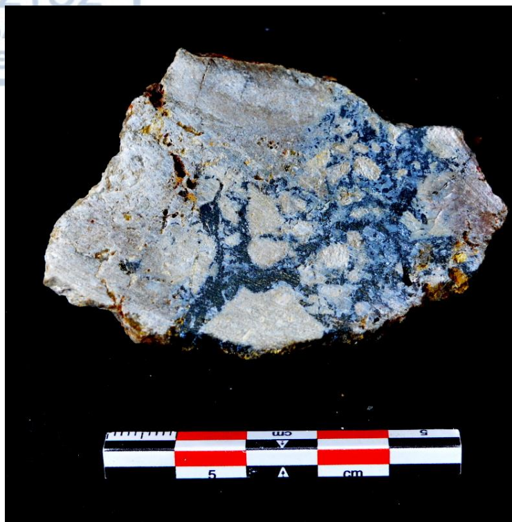
Εικ. 5.3.3. Μακροσκοπική εικόνα του δείγματος RZN3 όπου διακρίνονται εξαλλοιωμένοι κλάστες γενεσίου και τα κενά να έχουν πληρωθεί με μεταλλοφορία αντιμονίτη.
