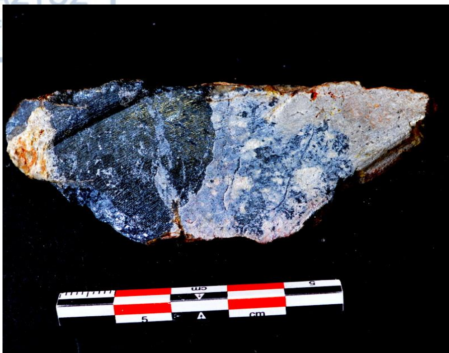
Εικ. 5.3.8. Μακροσκοπική εικόνα του δείγματος RZN3β. Διακρίνονται μεταλλοφορία αντιμονίτη και κλάστες εξαλλοιωμένου γνευσίου.
