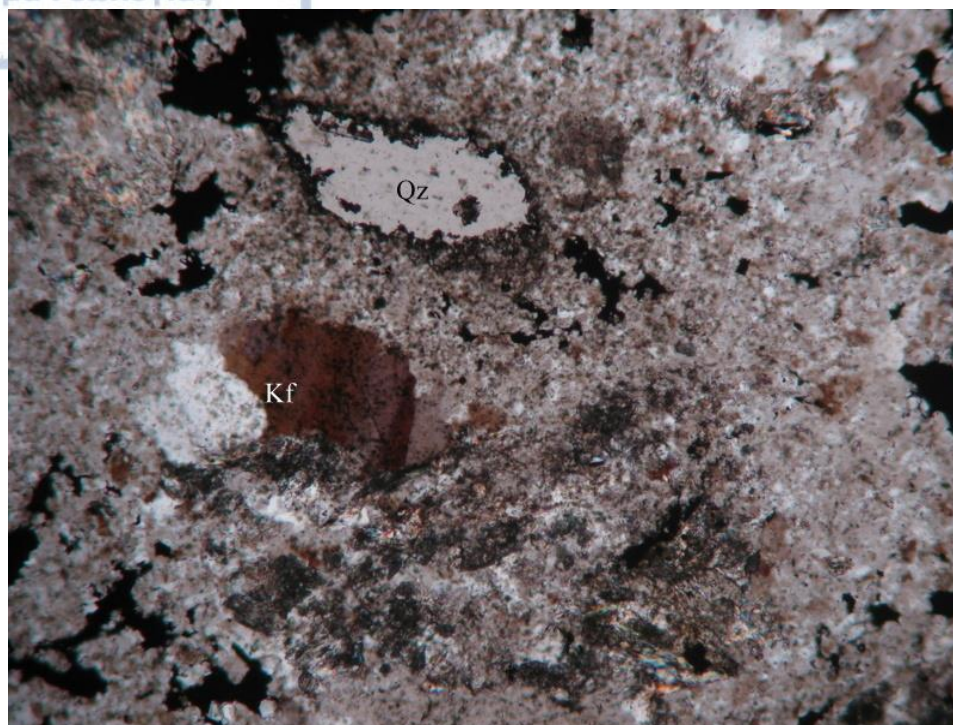
Εικ. 5.2.14. Παρατήρηση της προηγούμενης περιοχής με πολωτή και αναλυτή. Διακρίνονται χαλαζίας (Qz) και Κ-άστριος (Kf). Μήκος φωτογραφίας = 2.6 mm.
