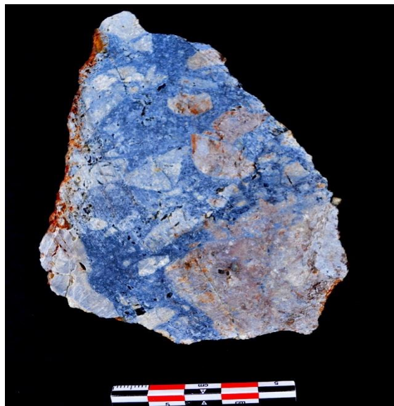
Εικ. 5.3.11. Μακροσκοπική εικόνα του δείγματος RZN7. Διακρίνονται κλάστες εξαλλοιωμένου γνευσίου και μεταλλοφορία αντιμονίτη πλήρωσης κενών.
