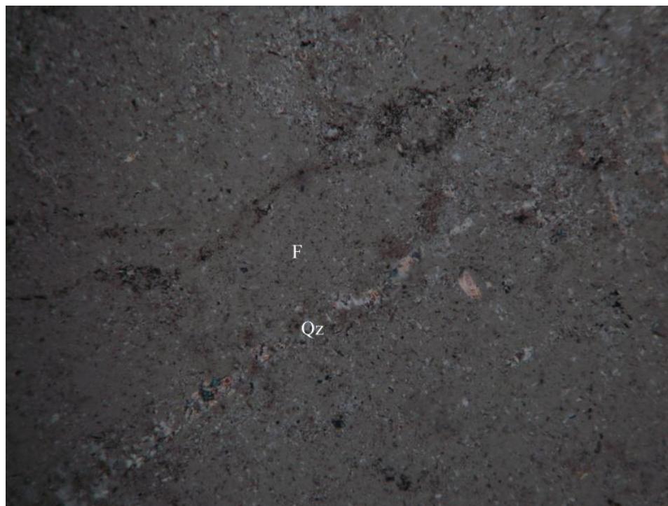
Εικ. 5.2.10. Παρατήρηση της προηγούμενης εικόνας με πολωτή και αναλυτή. Διακρίνονται φλεβίδιο υδροθερμικού χαλαζία (Qz) που διεισδύει σε άστρο (F). Μήκος φωτογραφίας = 2.6 mm.
