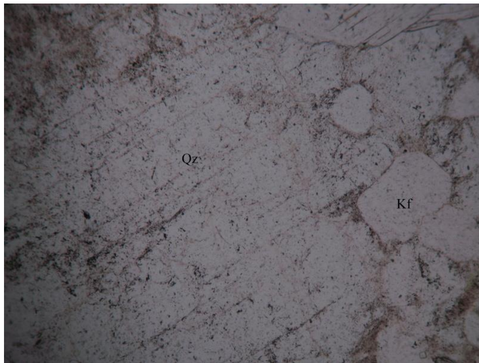
Εικ. 5.2.1. Τομή RZN1 κάτω από το πολωτικό μικροσκόπιο. Παρατήρηση μόνο με τον πολωτή. Διακρίνονται χαλαζίας (Qz) και αποστρογγυλεμένος Κ-άστριος (Kf). Μήκος φωτογραφίας = 2.6 mm.
