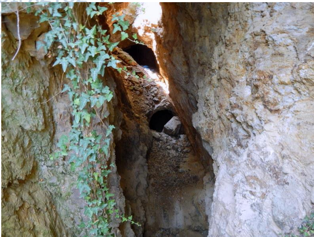
Εικ. 3.2.5. Στοές που κόβουν ρήγμα όπου εμφανίζεται η μεταλλοφορία στα Ριζανά. Διάνοιγμα πολλαπλών επιπέδων που ακολουθούν την μεταλλοφορία.
