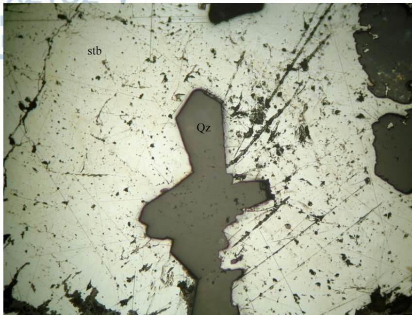
Εικ. 5.4.9. Μικροσκοπική εικόνα του δείγματος RZN3β. Διακρίνονται αντιμονίτης (stb) και κλάστες συνδρόμου ποικίλου μεγέθους. Το σχήμα του συνδρόμου στο κέντρο παραπέμπει σε χαλαζία (Qz). Μήκος φωτογραφίας = 2.6 mm.
