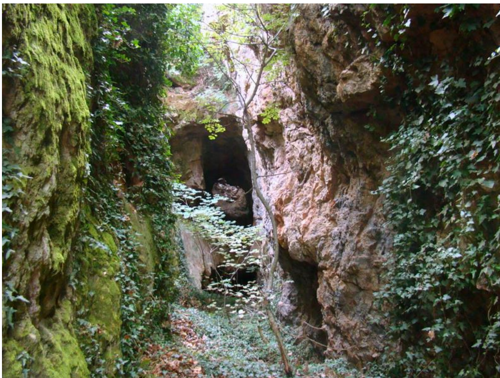
Εικ. 3.2.4. Στοές που κόβουν ρήγμα όπου εμφανίζεται η μεταλλοφορία στα Ριζανά. Διάνοιγμα πολλαπλών επιπέδων που ακολουθούν την μεταλλοφορία.
