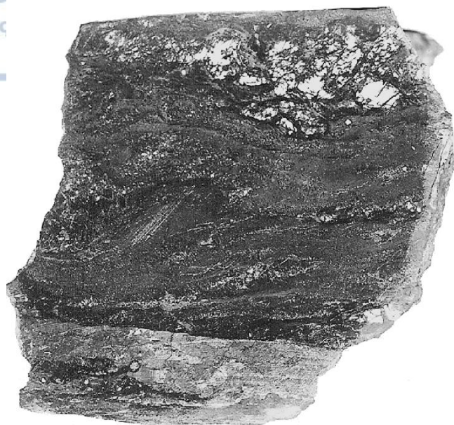
Εικ. 3.1.2. Φλέβα αντιμονίτη σε επαφή με χαλαζία και βαρύτη από το κοίτασμα στην Sarilakh-Sentachan της Ρωσίας (Bortnikov et al., 2010).
