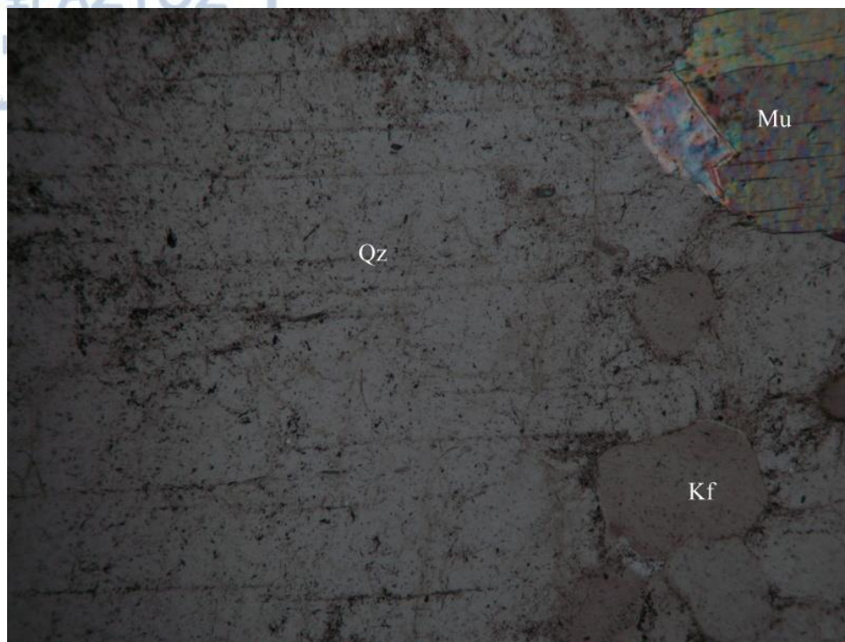
Εικ. 5.2.2. Παρατήρηση της προηγούμενης εικόνας με πολωτή και αναλυτή. Διακρίνονται χαλαζίας (Qz), Κ-άστριος (Kf) και λευκός μαρμαρυγίας (Mu). Μήκος φωτογραφίας = 2.6 mm.
