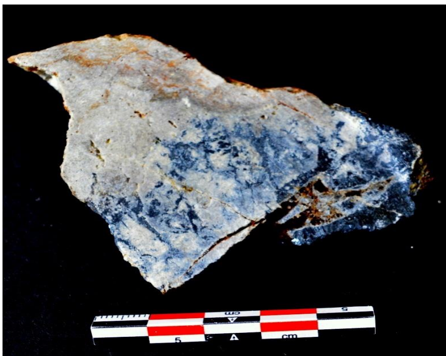
Εικ. 5.3.7. Μακροσκοπική εικόνα του δείγματος RZN3β. Διακρίνονται μεταλλοφορία αντιμονίτη και κλάστες εξαλλοιωμένου γνευσίου.
