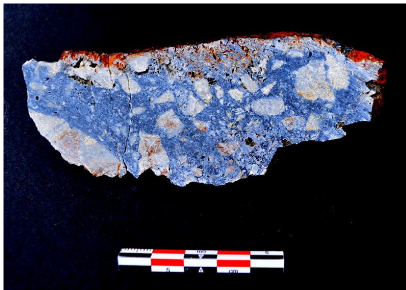
Εικ. 5.1.3. Brecciated γνεύσιος με μεταλλοφορία αντιμονίτη.
