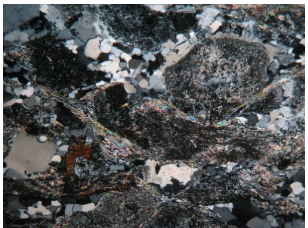
Εικ. 4.2. Φωτογραφία από πολωτικό μικροσκόπιο της τομής TH-20 με Nicols - και Nicols+ και οπτικό φακό 5x10.
