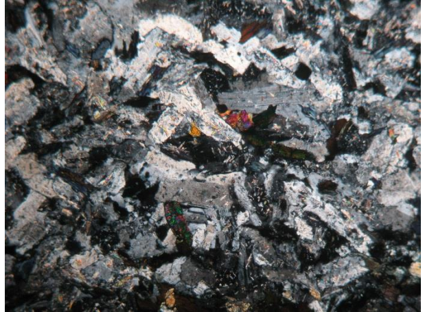
Εικ. 4.34. Φωτογραφία από πολωτικό μικροσκόπιο της τομής GA-7E με Nicols- και Nicols+ και οπτικό φακό 5×10.
