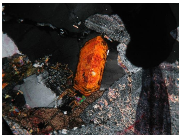
Εικ. 4.21. Φωτογραφία από πολωτικό μικροσκόπιο της τομής FO-1 με Nicols- και Nicols+ και οπτικό φακό 5×10.
