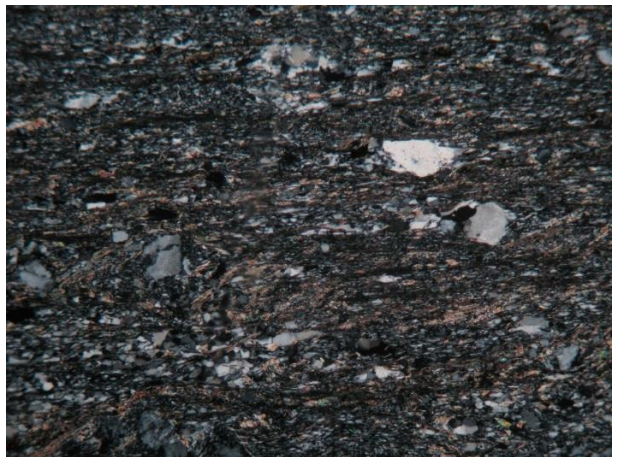
Εικ. 4.3. Φωτογραφία από πολωτικό μικροσκόπιο της τομής FO-6 με Nicols - και Nicols+ και οπτικό φακό 5x10.
