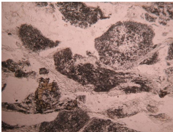
Εικ. 4.2. Φωτογραφία από πολωτικό μικροσκόπιο της τομής TH-20 με Nicols - και Nicols+ και οπτικό φακό 5x10.
