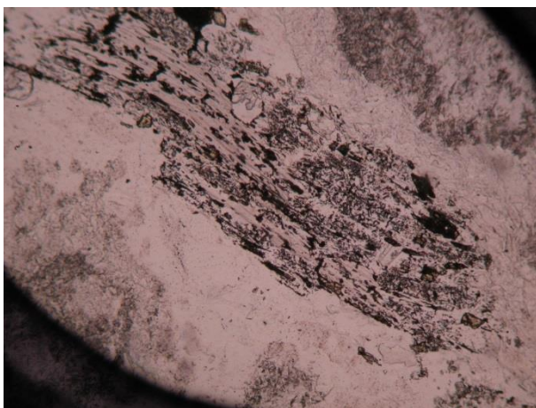
Εικ. 4.13. Φωτογραφία από πολωτικό μικροσκόπιο της τομής FO-10 με Nicols- και Nicols+ και οπτικό φακό 10×10.
