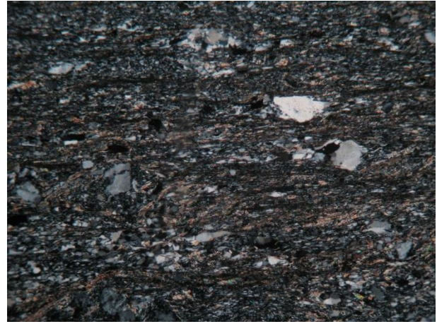
Εικ. 4.38. Φωτογραφία από πολωτικό μικροσκόπιο της τομής FO-6 με Nicols- και Nicols+ και οπτικό φακό 5×10.
