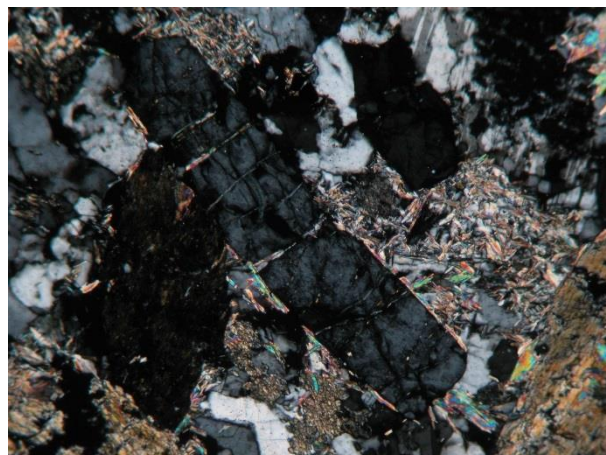
Εικ. 4.19. Φωτογραφία από πολωτικό μικροσκόπιο της τομής FO-3 με Nicols- και Nicols+ και οπτικό φακό 10×10.
