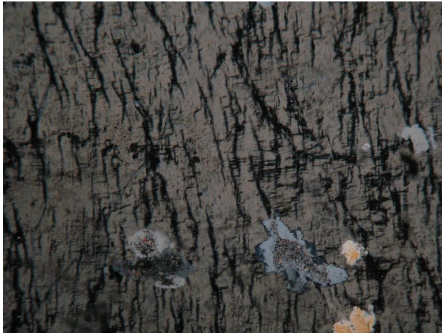
Εικ. 4.10. Φωτογραφία από πολωτικό μικροσκόπιο της τομής FO-15 με Nicols+ και οπτικό φακό 5×10.
