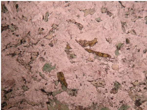
Εικ. 4.34. Φωτογραφία από πολωτικό μικροσκόπιο της τομής GA-7E με Nicols- και Nicols+ και οπτικό φακό 5×10.
