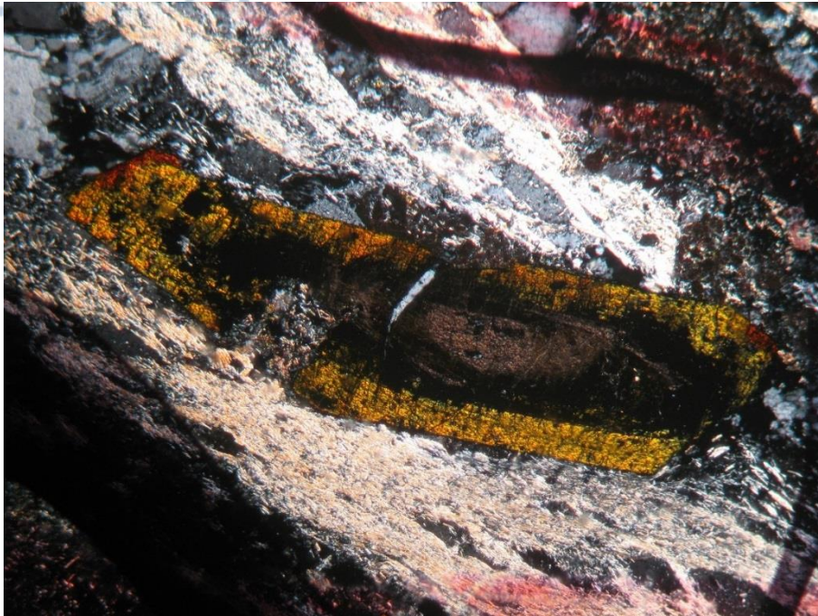
Εικ. 4.22. Φωτογραφία από πολωτικό μικροσκόπιο της τομής TH-13 με Nicols+ και οπτικό φακό 10×10.
