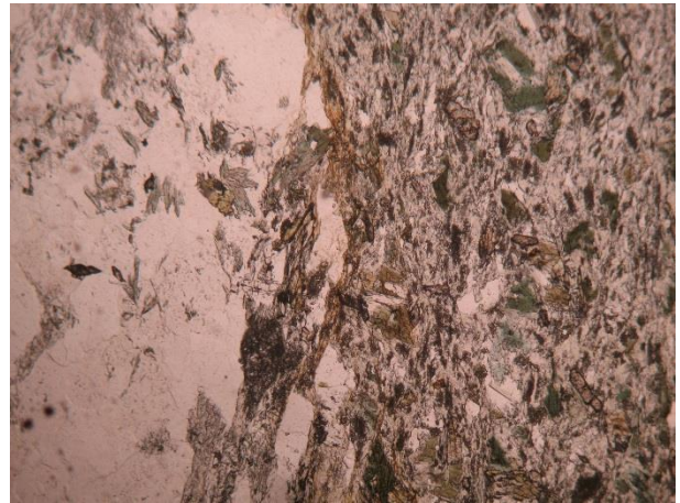
Εικ. 4.1. Φωτογραφία από πολωτικό μικροσκόπιο της τομής TH-21 με Nicols - και Nicols+ και οπτικό φακό 5x10.
