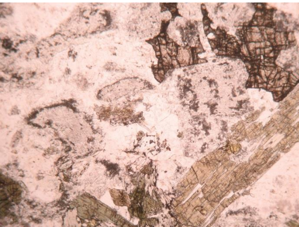
Εικ. 4.33. Φωτογραφία από πολωτικό μικροσκόπιο της τομής FO-11E με Nicols- και Nicols+ και οπτικό φακό 5×10.
