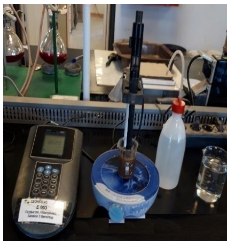
Εικόνα 3.11. Διάταξη μέτρησης του pH των εξεταζόμενων δειγμάτων (ΓΕΩΕΛΛΑΣ Α.Μ.Μ.Α.Ε.).
