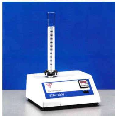
Εικόνα 3.8. Συσκευή για τη μέτρηση της πυκνότητας μετά από δόνηση (ΓΕΩΕΛΛΑΣ Α.Μ.Μ.Α.Ε).
