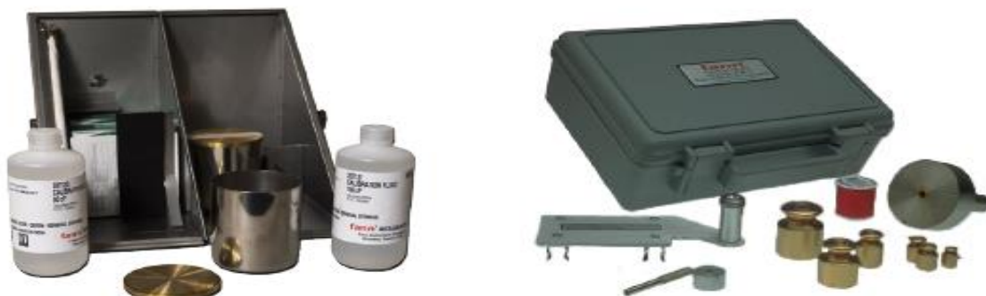
Εικόνα 6.2. Εργαλεία για τη διακρίβωση του ιξωδόμετρου Fann model 35SA.
