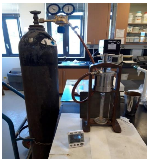
Εικόνα 6.3. Συσκευή διήθησης με παροχή αζώτου (ΓΕΩΕΛΛΑΣ Α.Μ.Μ.Α.Ε.).
