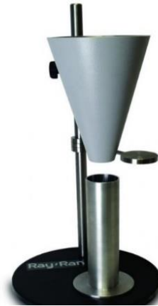
Εικόνα 3.7. Διάταξη για τον υπολογισμό της φαινόμενης πυκνότητας (Πηγή https://www.unitedtesting.com/en-us/apparent-bulk-density-apparatus )
