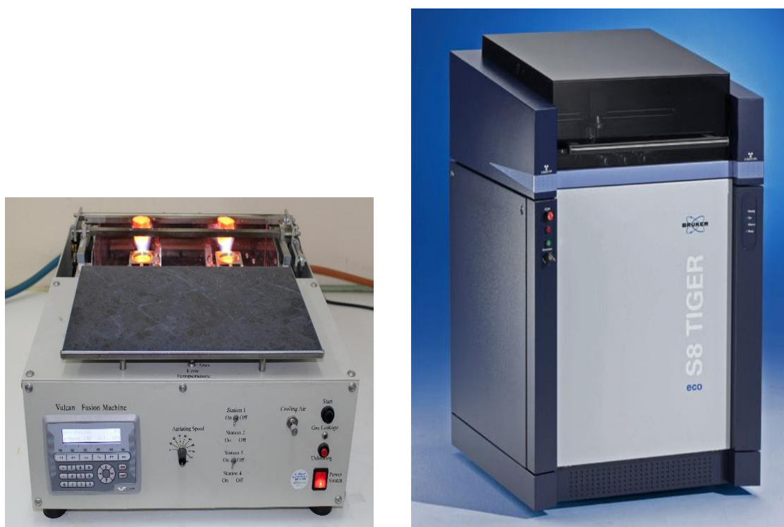
Εικόνα 3.14. Συσκευή Vulcan για την παρασκευή υαλοποιημένων δισκίων του Τομέα Ορυκτολογίας-Πετρολογίας-Κοιτασματολογίας του Α.Π.Θ. (αριστερά) και φασματόμετρο ακτίνων-X φθορισμού Bruker τύπου S8 Tiger του διατμηματικού εργαστηρίου ηλεκτρονικής μικροσκοπίας του Α.Π.Θ. (δεξιά).
