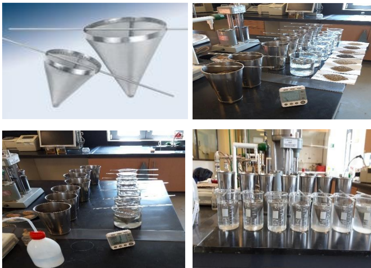
Εικόνα 3.9. Διάταξη μέτρησης της απορόφησης νερού των εξεταζόμενων δειγμάτων (ΓΕΩΕΛΛΑΣ Α.Μ.Μ.Α.Ε.).
