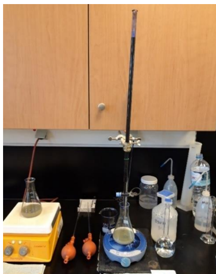
Εικόνα 3.12. Μέτρησης της ιοντοανταλλακτικής ικανότητας των εξεταζόμενων δειγμάτων (ΓΕΩΕΛ-ΛΑΣ Α.Μ.Μ.Α.Ε.).
