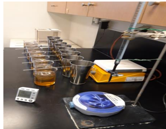
Εικόνα 3.10. Διάταξη μέτρησης της απορρόφησης ελαίου των εξεταζόμενων δειγμάτων (ΓΕΩΕΛΛΑΣ Α.Μ.Μ.Α.Ε.).
