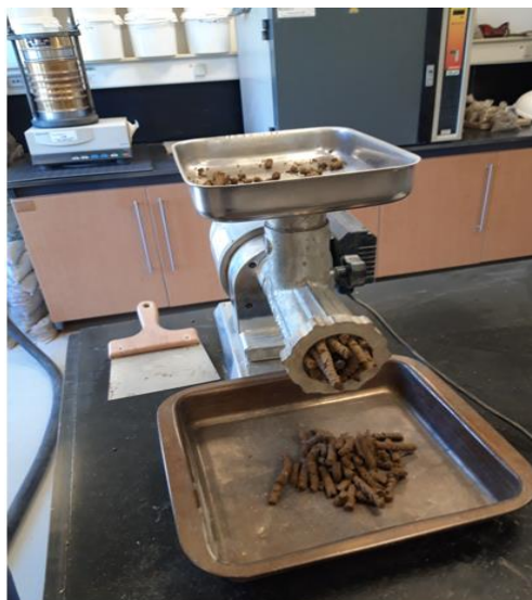
Εικόνα 3.15. Η συσκευή εξώθησης των εξεταζόμενων δειγμάτων (ΓΕΩΕΛΛΑΣ Α.Μ.Μ.Α.Ε.).
