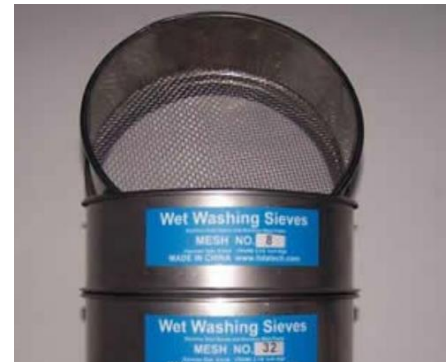
Εικόνα 3.10 Κόσκινα διαφορετικών μεγεθών κλίμακας Mesh, ( PetroServices GmbH Training Centre, "Basic Mud Logging Guide" ).
