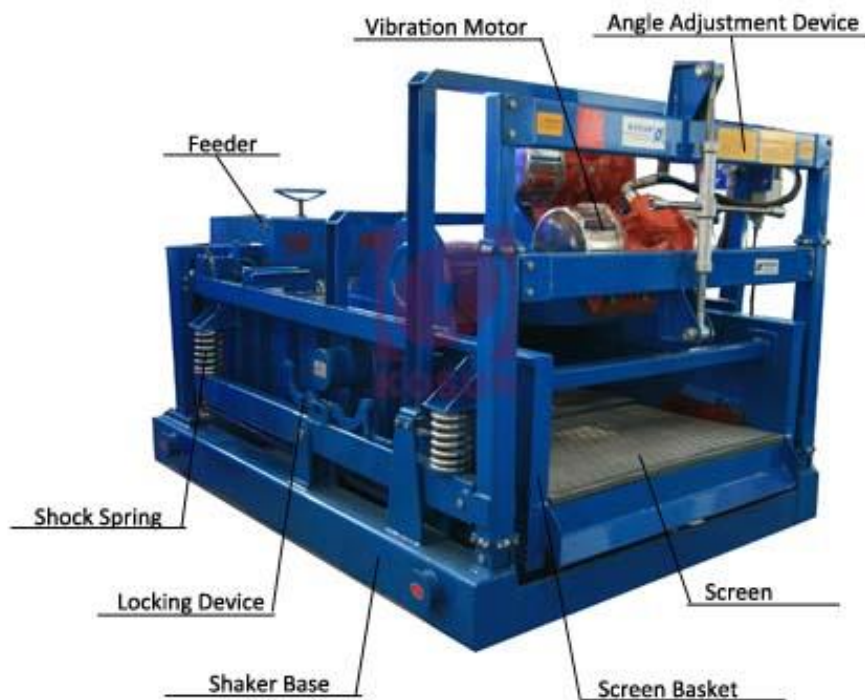
Εικόνα 1.3 Shale Shaker και τα επιμέρους μέρη του.
