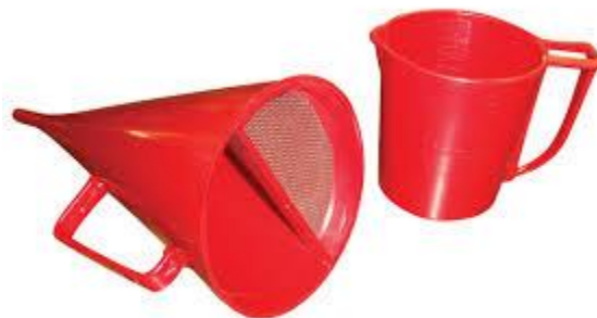
Εικόνα 2.2 Χοάνη διοχέτευσης λάσπης και μέτρησης ιξώδους.
