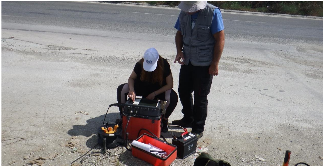
Εικόνα 39: Χρήση σειсмоγράφου Geometrics StrataView 48 καναλιών υπό την καθοδήγηση διδακτικού- ερευνητικού προσωπικού, όπου φαίνεται στα δεξιά η σύνδεση με την μπαταρία των 12Volts και στα αριστερά του οργάνου η σύνδεση με τα γεώφωνα.
