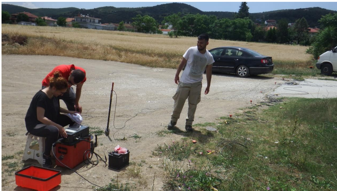
Εικόνα 35: Στη σεισμική γραμμή L3 φαίνεται η τοποθέτηση των γεωφώνων, ο σειсмоγράφος που χρησιμοποιήθηκε, η μεταλλική πλάκα και η σεισμική σφύρα η οποία είναι συνδεδεμένη μέσω καλωδίου με το σύστημα καταγραφής έτσι ώστε όταν γίνεται η κρούση στην μεταλλική πλάκα να πυροδοτεί άμεσα την έναρξη καταγραφής της εδαφικής κίνησης.
