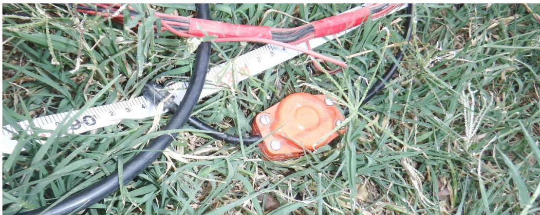
Εικόνα 37: Καλή τοποθέτηση γεωφώνου ύστερα από εκκαθάρισή βλάστησης για την μείωση απώλειας του σήματος.
