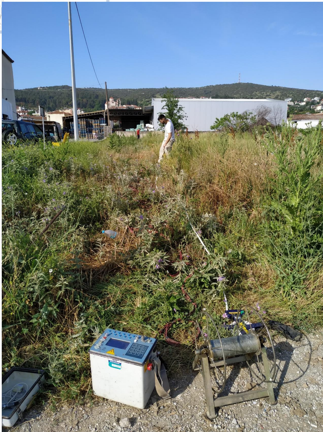
Εικόνα 54: Εξοπλισμός μέτρησης ηλεκτρικών τομογραφιών. Παρατηρούνται τμήματα της γραμμής των ηλεκτροδίων κατά την πραγματοποίηση της τομογραφίας L1, που είναι συνδεδεμένα με τα πολυπύρρηνα καλώδια και τα οποία με τη σειρά τους είναι συνδεδεμένα με το όργανο μέτρησης και αποθήκευσης των μετρήσεων SYSCAL-Pro.
