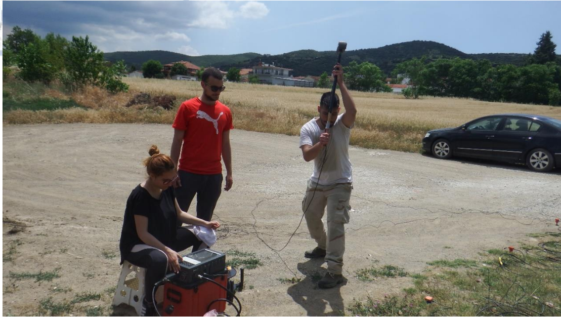
Εικόνα 34: Παραγωγή σεισμικών κυμάτων στην σεισμική γραμμή L3 με χρήση σεισμικής σφύρας.
