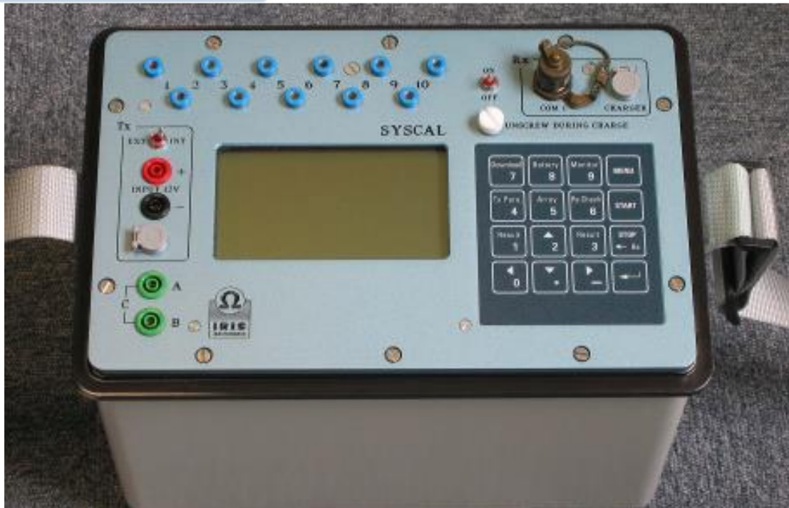
Εικόνα 53: Το όργανο SYSCAL-Pro που χρησιμοποιήθηκε για τη λήψη των ηλεκτρικών μετρήσεων.
