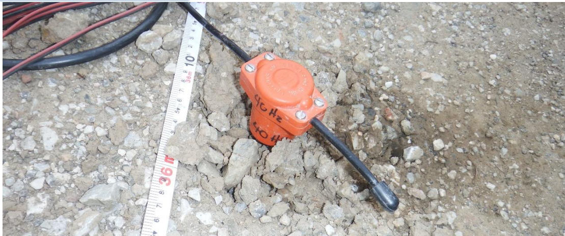
Εικόνα 36: Τοποθέτηση των γεωφώνων συχνότητας 40Hz σε όσο καλύτερη επαφή γίνεται με το έδαφος για την σωστότερη καταγραφή του σήματος.
