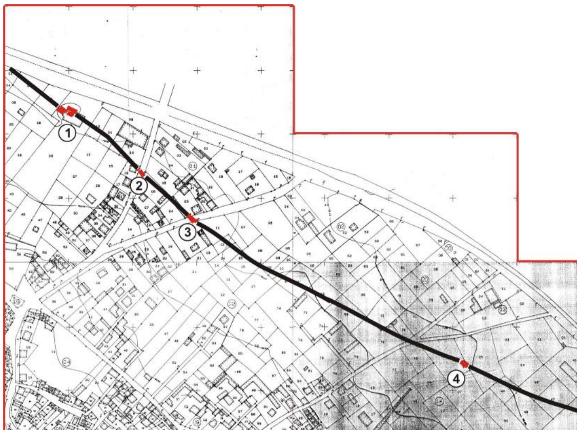
Εικόνα 1: Τοπογραφικός χάρτης της περιοχής μελέτης. Με κόκκινο χρώμα και αρίθμηση απεικονίζονται οι θέσεις όπου παρατηρούνται ζημιές σε κατασκευές από τη δράση του ρήγματος, ενώ με μαύρη έντονη γραμμή απεικονίζεται η πιθανή θέση του ρήγματος στις ενδιάμεσες περιοχές. (Χατζηπέτρος, 2006)
