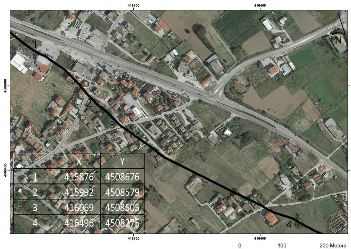
Εικόνα 2: Δορυφορική εικόνα όπου φαίνονται οι συντεταγμένες των θέσεων στις οποίες παρατηρούνται ζημιές στις κατασκευές από τη δράση του ρήγματος.
