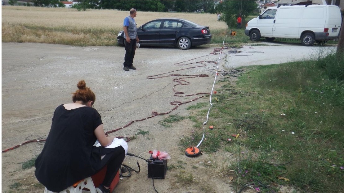
Εικόνα 32: Στη σεισμική γραμμή L3 φαίνεται η τοποθέτηση των γεωφώνων με 2m απόσταση μεταξύ τους και ο σειсмоγράφος Geometrics StrataView 48 καναλιών.
