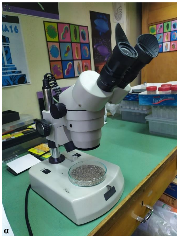
Εικόνα 19. α. Το στερεοσκόπιο Motic SMZ-140 SERIES όπου πραγματοποιήθηκε η διαλογή των τρηματοφόρων, β. Τα εργαλεία που χρησιμοποιήθηκαν στο αρχικό στάδιο επεξεργασίας των τρηματοφόρων.
