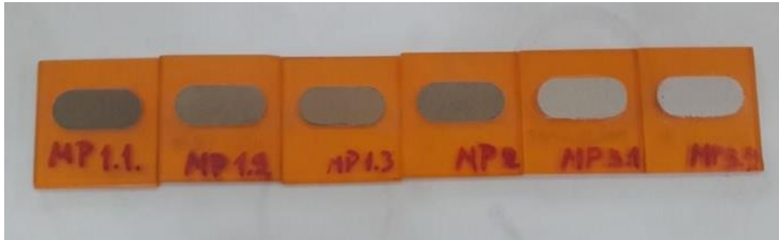
Εικόνα 6.2.1.2: Τελικά δείγματα τοποθετημένα στους ειδικούς συλλέκτες για ανάλυση με τη μέθοδο Περιθλασιμετρίας ακτίνων Χ.
