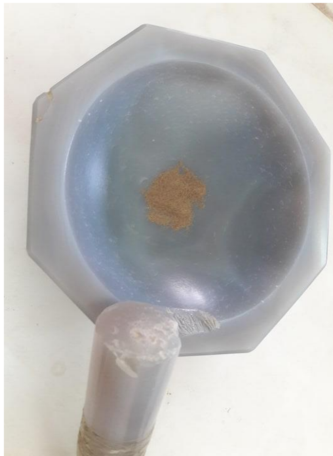
Εικόνα 6.2.1.1: Κονιοποίηση αντιπροσωπευτικού δείγματος στο αχάτινο γουδί μέχρι να γίνει αναφής σκόνη.
