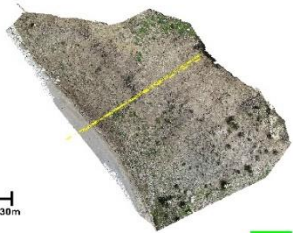
Εικόνα 6.8: Σύγκριση μορφολογικών τομών της περιοχής έρευνας. Με μαύρο χρώμα διακρίνεται η μορφολογική τομή του έτους 2017, αποτελώντας τομή αναφοράς στη σύγκριση με αυτές των ετών 2018 (κόκκινο χρώμα) και 2019 (πράσινο χρώμα). Αριστερά παρουσιάζονται με κίτρινο χρώμα τα ίχνη των μορφολογικών τομών σε κατόψεις της περιοχής έρευνας, ενώ δεξιά διακρίνονται τα ίχνη των τομών σε φωτογραφίες του πρανούς.
