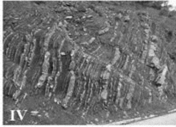
Τύπος IV. Μέτρια διαταραγμένη βραχώμαζα αποτελούμενη από εναλλαγές ψαμμίτη-ιλυολίθου σε ίσες αναλογίες
