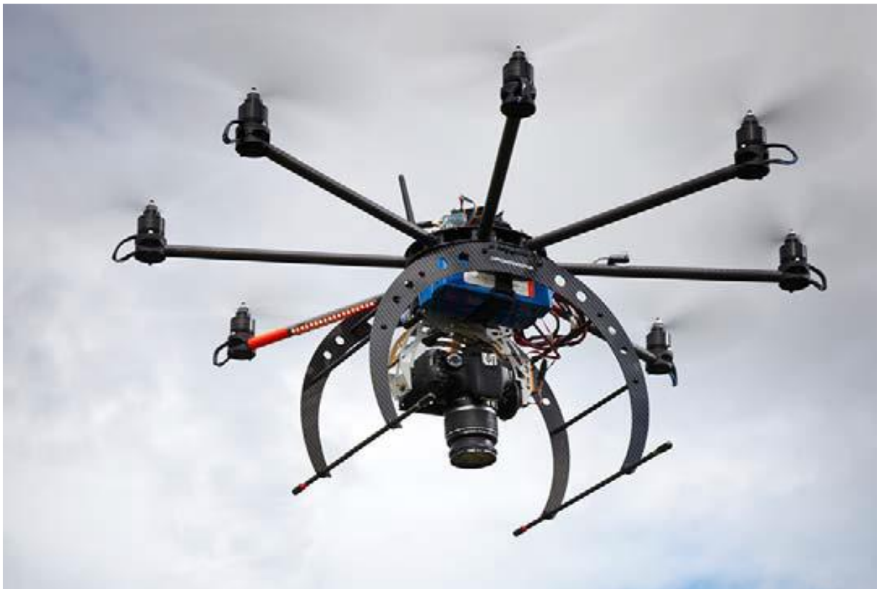
Εικόνα 4.4: Τηλεκατευθυνόμενο ΣμηΕΑ (UAV) με οκτώ έλικες, ψηφιακή κάμερα και σύστημα πλοήγησης GPS (Lucieer et.al, 2014).
