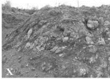
Τύπος X. Τεκτονικά παραμορφωμένος, έντονα πτυχωμένος, ρηγματωμένος ιλυόλιθος ή αργιλικός σχιστόλιθος με κερματισμένα και παραμορφωμένα ψαμμιτικά τεμάχια τα οποία διαμορφώνουν σχεδόν χαστική δομή
