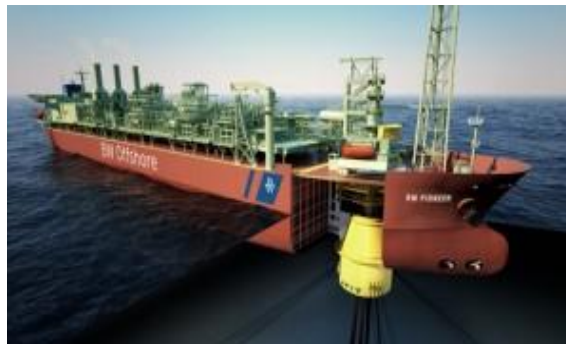
Εικόνα 19 - Turret Mooring System (εσωτερικό) [πηγή: https://2b1stconsulting.com/ ]
