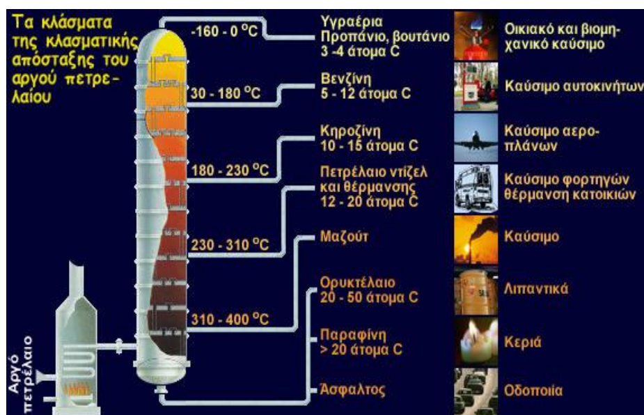
Εικόνα 29 - Η κλασματική απόσταξη του αργού πετρελαίου, τα προϊόντα της και οι χρήσεις των προϊόντων [πηγή: http://molwave.chem.auth.gr/ ]
