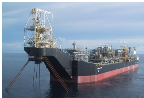
Εικόνα 20 - Turret Mooring System (εξωτερικό) [πηγή: http://d3739333.u52.houstonwebhost.net/ ]
