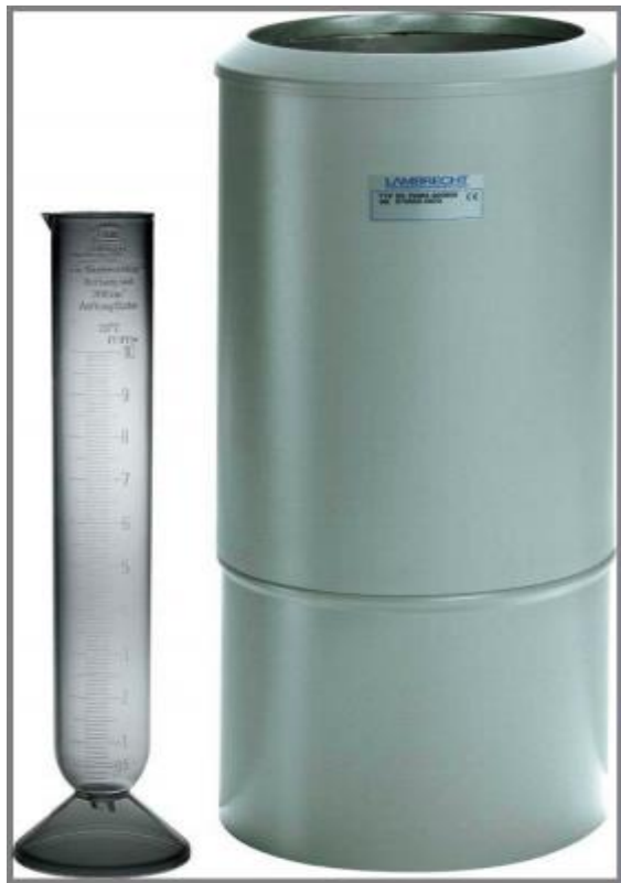
Σχ. 7: Τυπικό Βροχόμετρο
