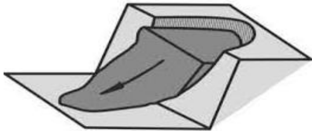
Εικόνα 17 Περιστροφική ολίσθηση (Muller 1963, Hoek & Bray 1981)
