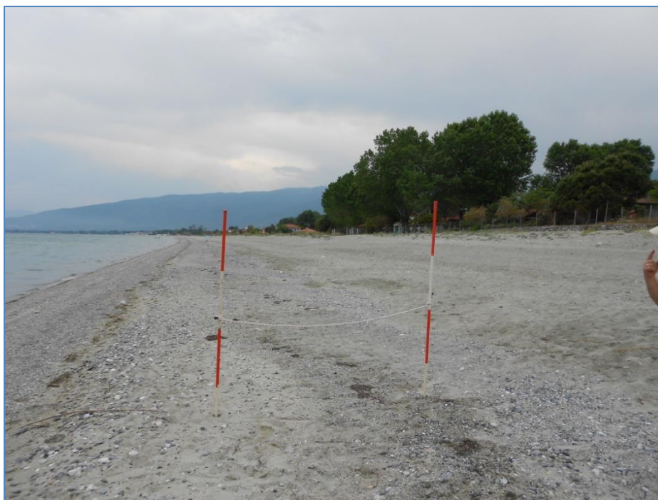
Φώτο 3.1 Η διάταξη με τα ακόντια έτσι όπως χρησιμοποιήθηκε για της έρευνα πεδίου.
