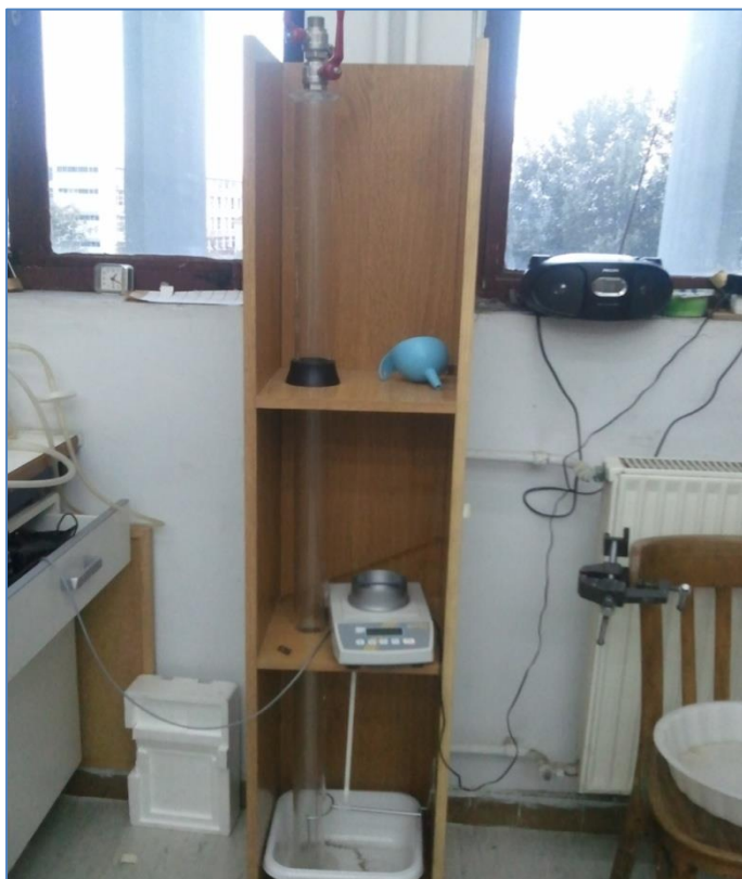
Φώτο 3.3 Διάταξη σωλήνα καθίζησης που χρησιμοποιήθηκε για τον υπολογισμό κοκκομετρίας της άμμου.
