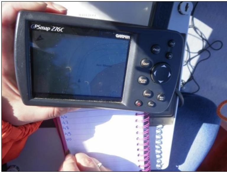
Φώτο 3.2. Καταγραφή βαθών περιοχής έρευνας με τη χρήση GARMING GPSMAP 276C.
