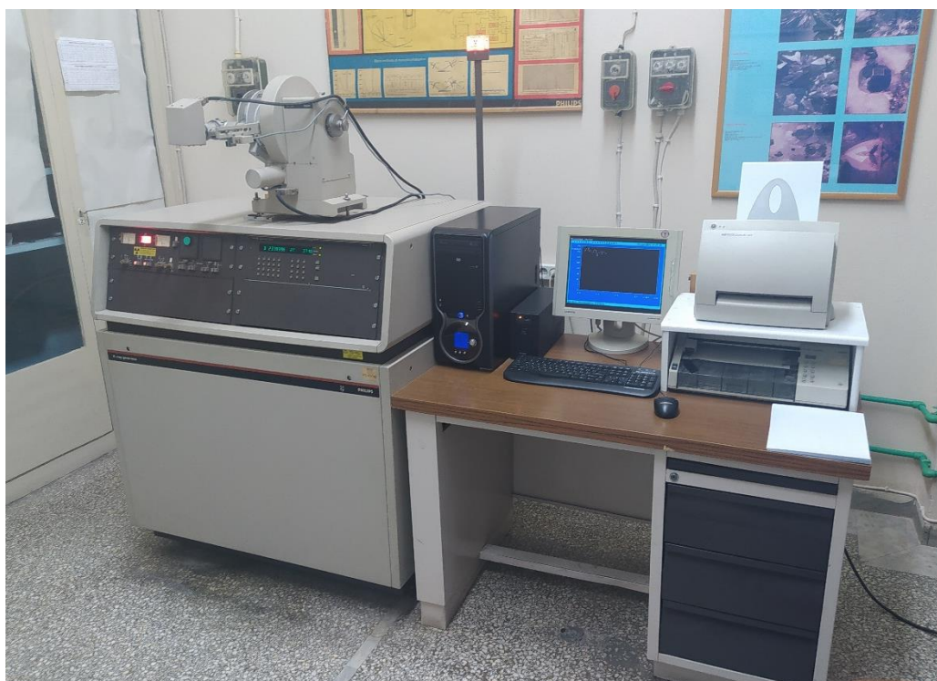
Εικόνα 7. Περιθλασιόμετρο τύπου Philips PW1820/00 του Τομέα Ορυκτολογίας - Πετρολογίας –Κοιτασματολογίας.
