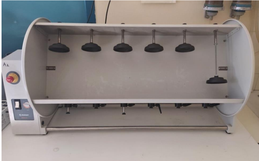
Εικόνα 4. Αναμίκτης Heidolph τύπου Reax 20/12 του Τομέα Ορυκτολογίας-Πετρολογίας-Κοιτασματολογίας του Α.Π.Θ.
