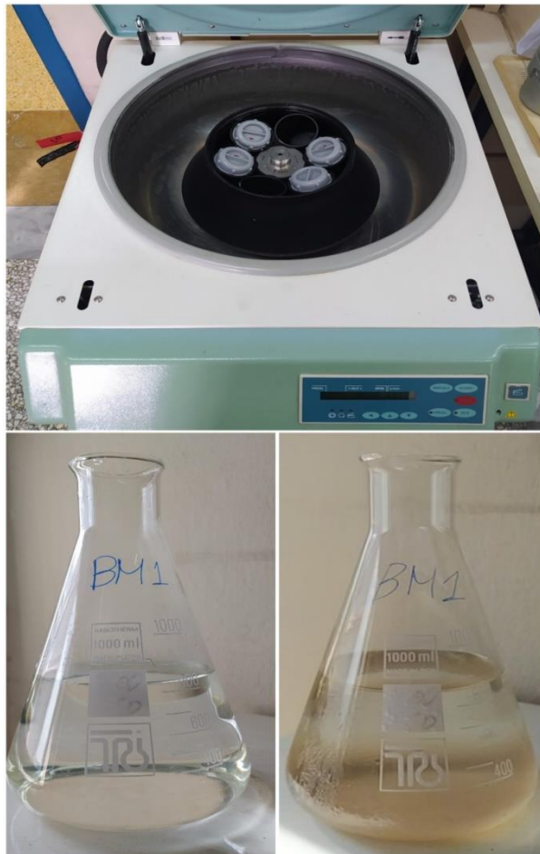
Εικόνα 6. Φυγόκεντρος Rotanda 460 (πάνω), το διάλυμά πριν (κάτω-δεξιά) και αφού απομακρυνθούν τα σωματίδια εδάφους (κάτω-αριστερά).
