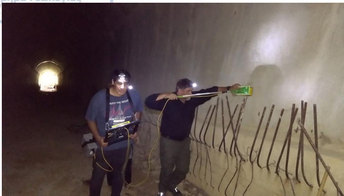
Σχήμα 5.3 Συλλογή δεδομένων με την κεραία 1000 MHz της Sensors & Software.
