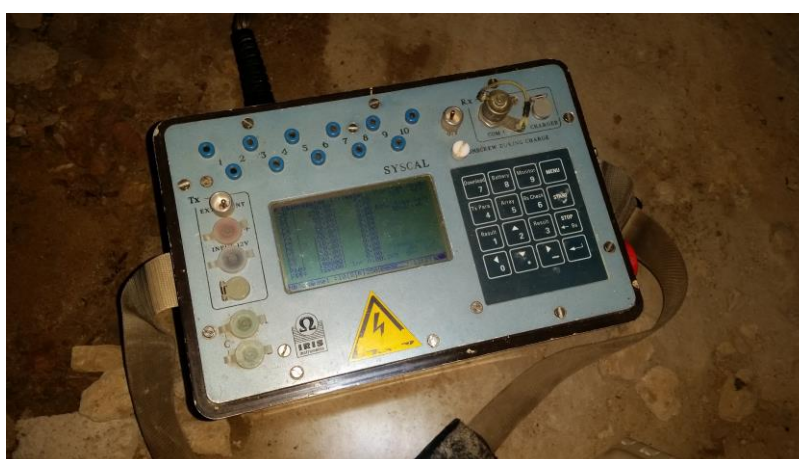
Σχήμα 5.9 Αριστερά χρήση ηλεκτροδίων κατά την εφαρμογή ηλεκτρικής τομογραφίας στο χώρο της σήραγγας, δεξιά στιγμιότυπο από την εκτέλεση των ηλεκτρικών μετρήσεων, κάτω γεωφυσικό όργανο μέτρησης Syscal Pro
