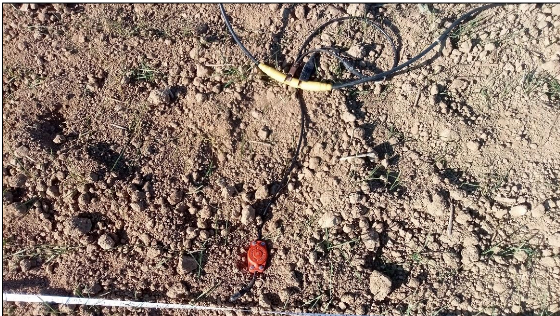
Εικόνα 128. Το καλώδιο σύνδεσης του γεωφώνου με τον σειсмоγράφο
