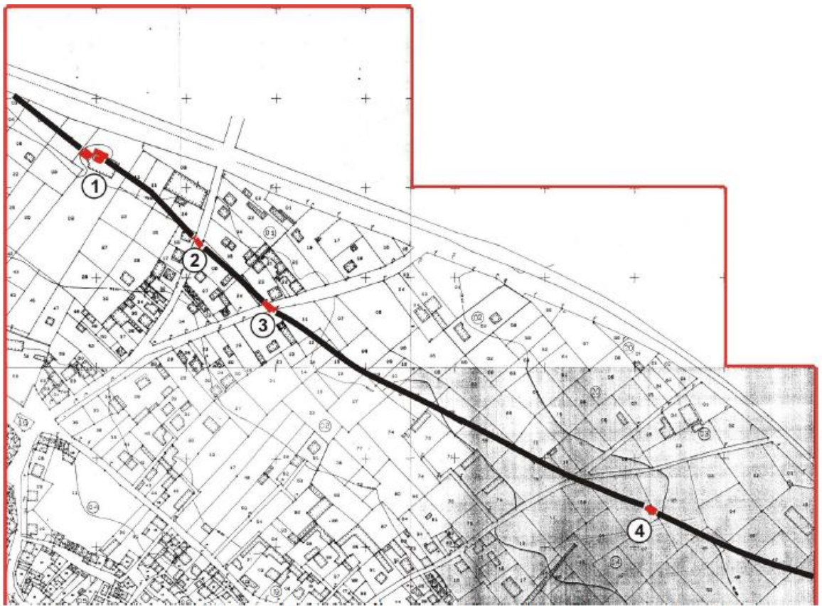
Εικόνα 1. Τεκτονικός Χάρτης περιοχής μελέτης. Με το κόκκινο χρώμα απεικονίζονται οι θέσεις στις οποίες παρατηρήθηκαν ζημιές σε κατασκευές από τη δράση του ρήγματος και με μαύρο χρώμα η πιθανή θέση του ρήγματος. (Chatzipetros,2006)
